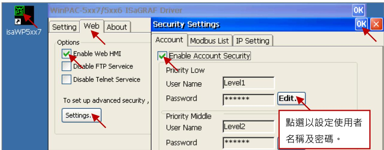
關於第一項 Modbus TCP/IP 的保護方式，您可以在控制器上設定開放最多 8 組 ISaGRAF 或其他 HMI 的 IP 可允許連線進來，如下圖。
