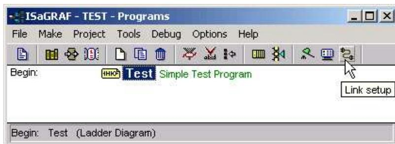
於 "PC-PLC Link Parameters" 對話框，選擇 "Ethernet" 為通訊選項，按 "Setup"。
