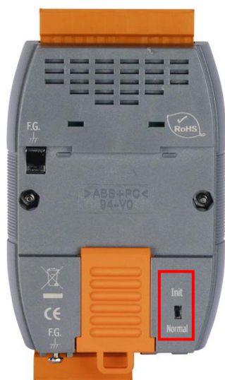
圖 2-1：控制器上的 Switch 位置圖
