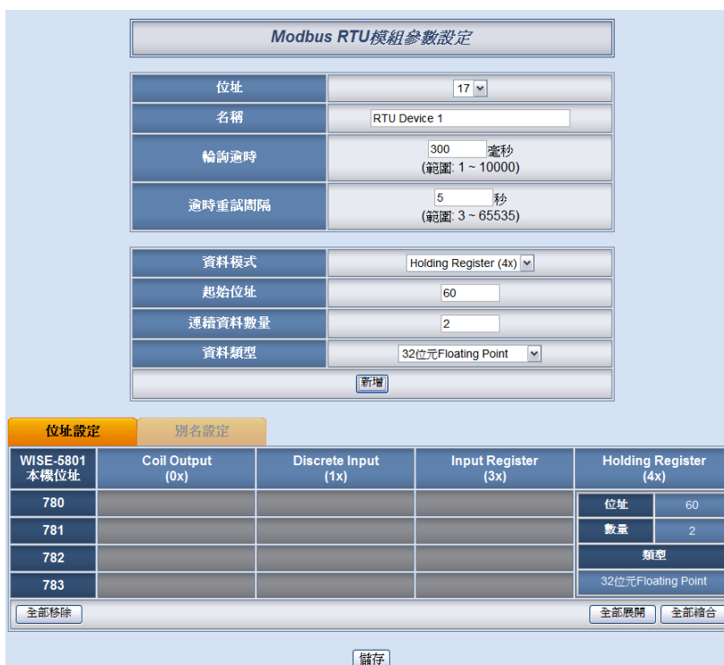
图 4-30: Modbus RTU Slave 模块 Holding Register 参数设定页面范例
