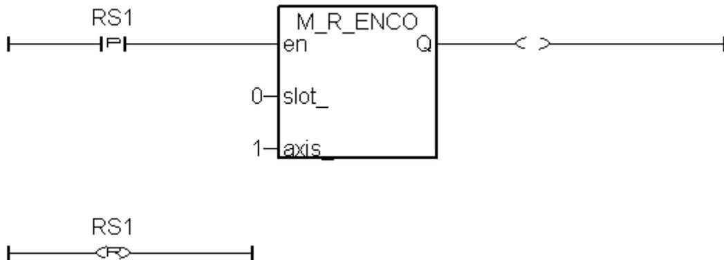
上方的程序是用來將 slot 0 上的 I-8093W (或 I-8090W) 的 X 軸 reset 為 0, 當 RS1 被設為 True 時, 該 encoder 值就會在下一個 PLC scan 一開始時被清為 0. ( “axis\_” 設為 1 表示 X 軸, 2 為 Y 軸, 3 為 Z 軸)
