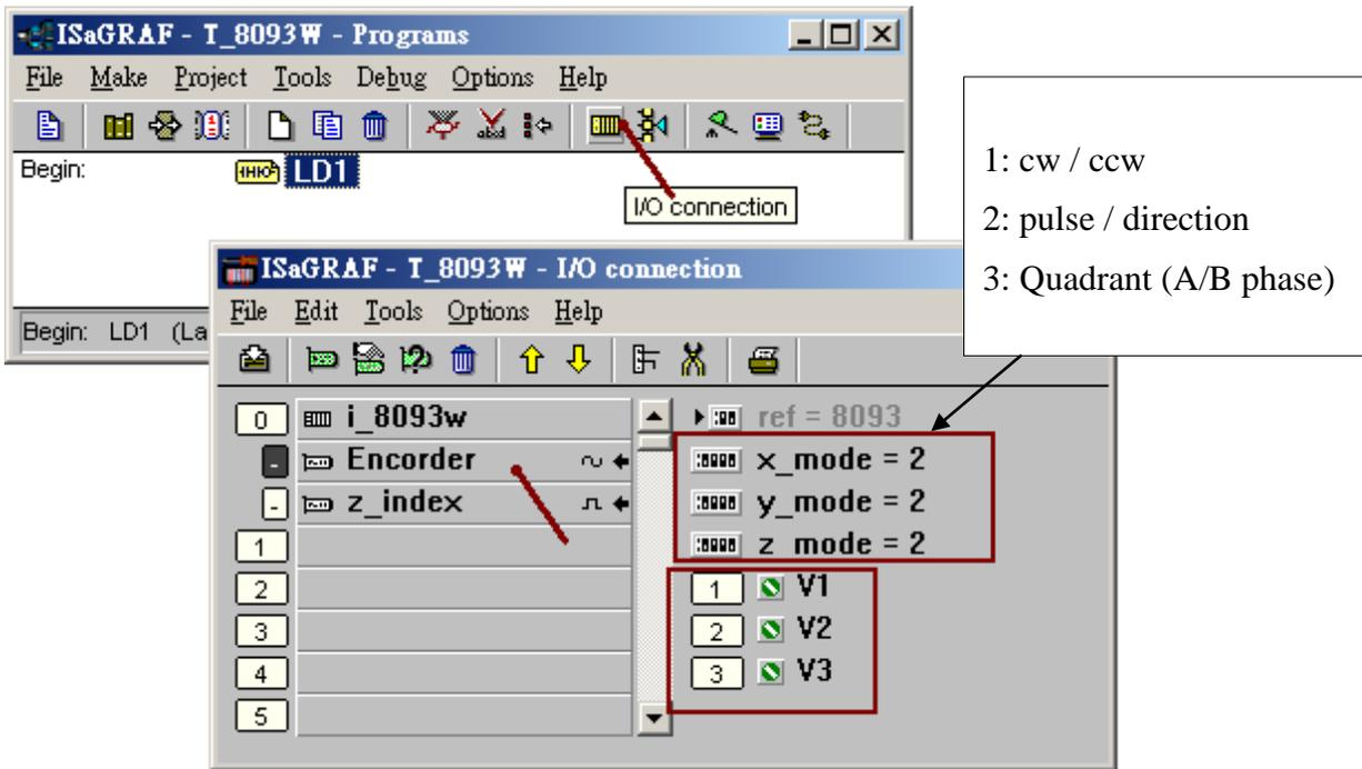
以上是將 I-8093W 插在控制器上的 slot 0, 並設定 X, Y, Z 軸的輸入模式為 2 (pulse / direction), 變數 V1, V2, V3 需宣告為 Interger / input. 其它可選用的輸入模式還有 1 (cw / ccw) 與 3 (A/B phase 或 Quadrant). 上圖 “z\_index” 內可以連上 3 個 Boolean / input 變數, 用來取得各軸的 Z-index DI.
