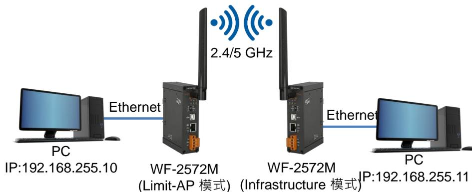
圖 7. Infrastructure 模式的測試架構
