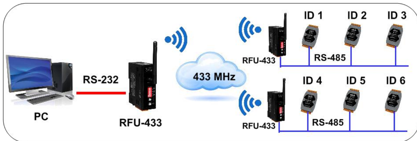
電腦透過一個 RFU-433 控制站號 1 ~ 3 的 RS-485 模組 並透過另一個 RFU-433 控制站號 4 ~ 6 的 RS-485 模組
