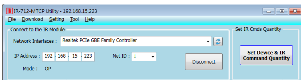
圖 3-7、與 IR-712-MTCP 建立 Modbus/TCP 連線介面
