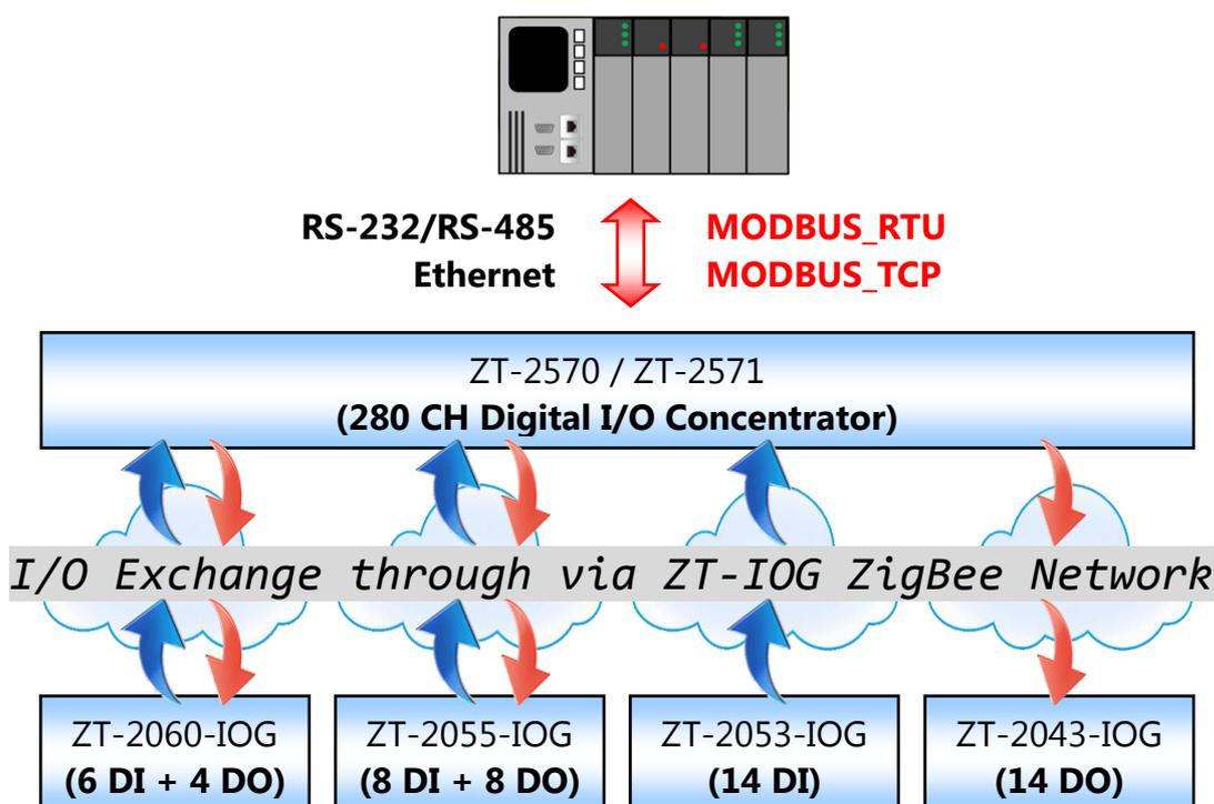
ZT-257x 模組的 DIO 資料集中器功能，提供最多 280 個 Digital 通道，可用來暫存網路內 ZT-20xx-IOG 模組的 DIO 通道狀態。使用前，必須先設定 ZT-20xx-IOG 模組的 **Channel Offset** ( DI/DO ) 參數，意即指定 ZT-20xx-IOG 模組的 DIO 通道 與 ZT-257x 模組的虛擬欄位 ( Modbus Register ) 之間的配對關係，以便使用對應位址遠端地讀取或寫入 ZT-20xx-IOG DIO 通道的狀態。
