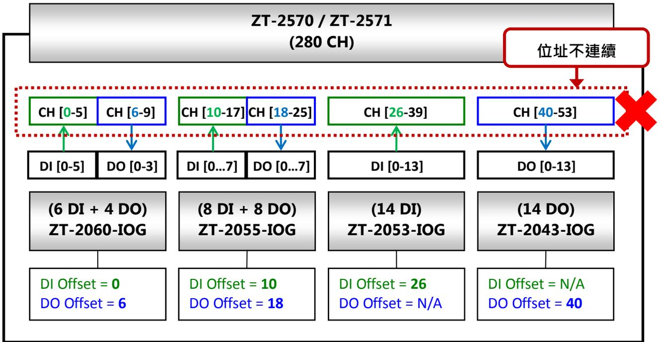
您可使用 ZT-20xx-IOG 軟體工具來設定 **Channel Offset** 的值，以下為 ZT-20xx-IOG 模組的設定範例：
