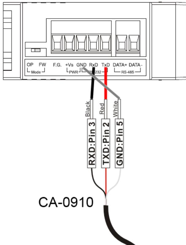
圖 2-6、CA-0910 傳輸線與 IR-210 接線腳位
