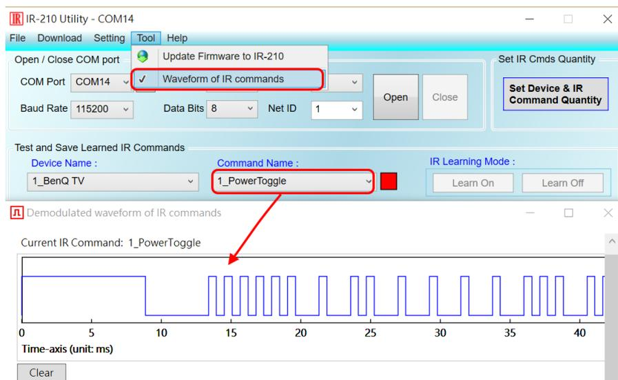
圖 3-23、開啟視窗顯示現前 IR 命令波形
