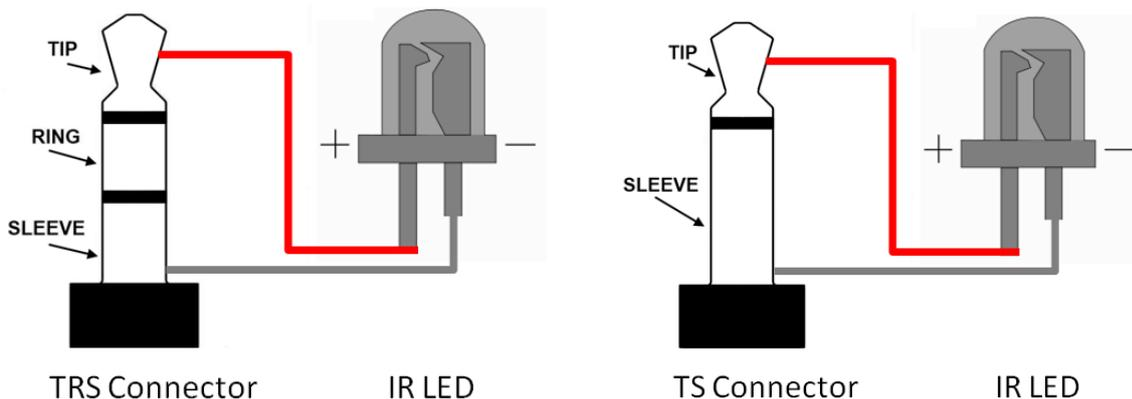
圖 2-8、TRS 接頭連接 IR LED
