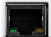
tSH-700 系列模块包含一个 RJ-45 插座，为 10/100 Base-TX 以太网标准端口。当侦测到网络有联机且有接收到网络封包的时候，此时 RJ-45 插座上的 **Link/Act LED 指示灯 (橘色)** 将亮起。当使用 PoE (Power-over-Ethernet) 方式供电开机，此时 RJ-45 插座上的 **PoE LED 指示灯 (绿色)** 将亮起。
