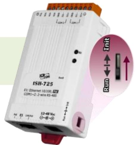
步驟 9: 在 “Init 模式”下，將 tSH-700 斷電再供電開機，重新啟動後開始進行更新。
