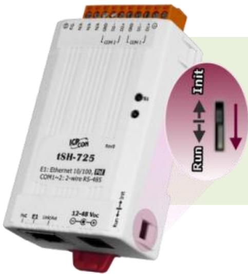
步驟 11: 更新完成後 (Complete: 100%)，再將 tSH-700 模組上的 “Init/Run 運作模式開關” 調回 “Run 模式” 狀態。
