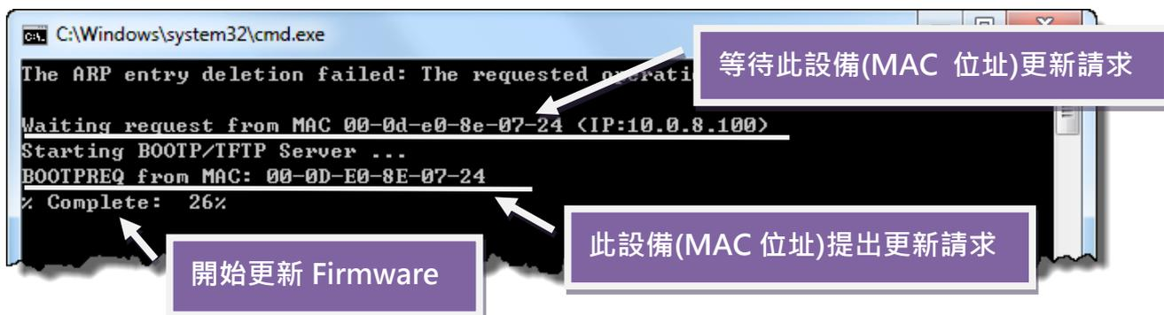
**注意:** 如果遠端 Firmware 更新失敗，此時模組將不能正常運作；請參閱 [第3.1節 BOOTP 模式下 Firmware 更新](#) (需本地端操作) 使模組恢復運作。
