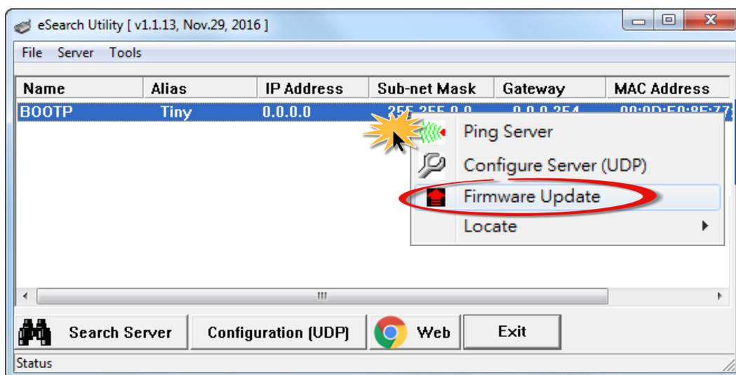
步驟 5: 請參考 “第 2 章-開始更新 Firmware” 的步驟 4 到步驟 17 來完成 Firmware 更新(後續更新程序步驟相同)。註: 此時模組的回應不帶 IP。在第 4 頁步驟 5 中，使用者需手動指定一個可用的 IP 位置給模組。
