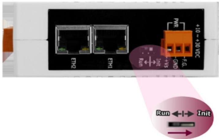
步驟 9: 在 “Init 模式”下，將 DS-2200 斷電再供電開機，重新啟動後開始進行更新。
