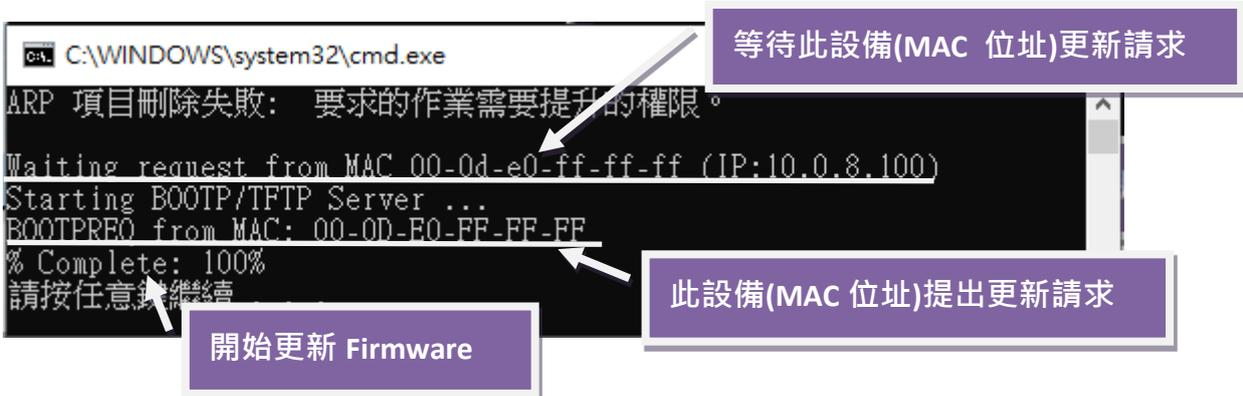
步驟 11: 更新完成後 (Complete: 100%)，再將 DS-2200 模組上的 “Init/Run 運作模式開關” 調回 “Run 模式” 狀態。
