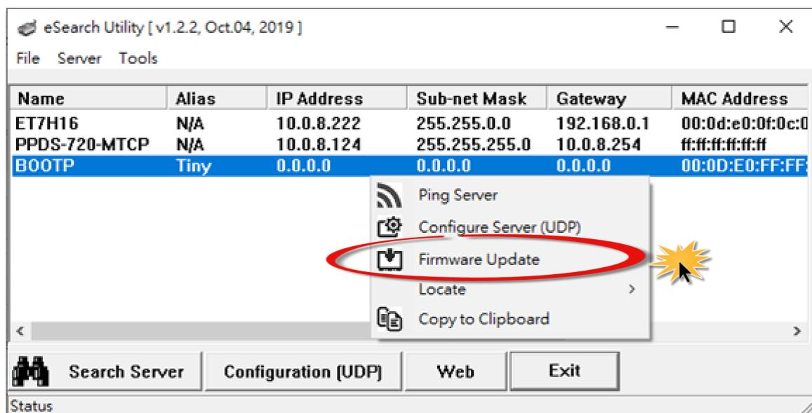
步驟 5: 請參考 “第 2 章-開始更新 Firmware”的步驟 4 到步驟 17 來完成 Firmware 更新(後續更新程序步驟相同)。註: 此時模組的回應不帶 IP。在第 3 頁步驟 5 中，使用者需手動指定一個可用的 IP 位置給模組。
