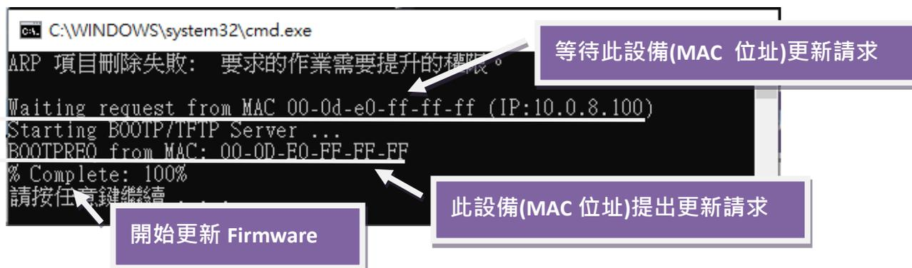
**注意:** 如果遠端 Firmware 更新失敗，此時模組將不能正常運作；請參閱[第 3.1 節 BOOTP 模式下 Firmware 更新](#) (需本地端操作) 使模組恢復運作。
