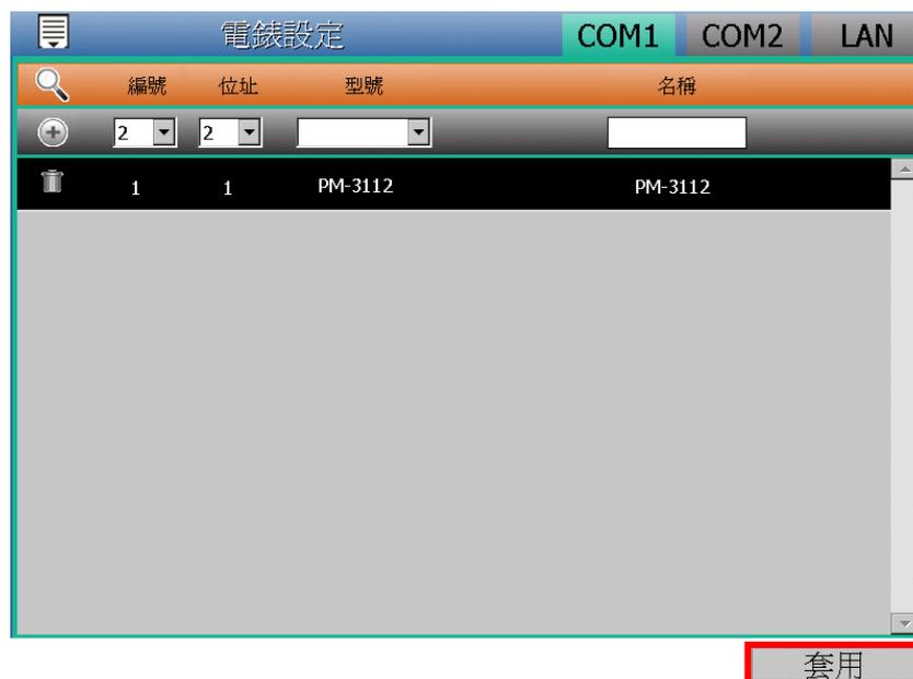
注意：當掃描不到電錶時，請再次確認 RS-485 線路串接正確，並至【介面設定】確認電錶所連接 COM Port 設定參數無誤，修改完畢請點選【套用】，並重新掃描。
