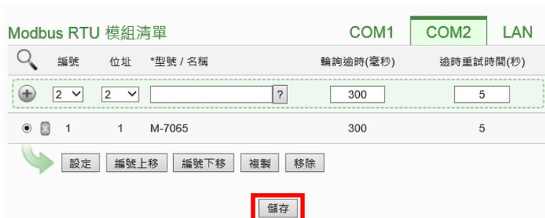
**注意：**當掃描不到 I/O 模組時，請再次確認 RS-485 線路串接正確，並至步驟(1)：【系統參數設定】→【I/O 介面設定】確認所連接 COM Port 設定參數無誤，修改完畢請點選【儲存】，並重覆步驟 3.a 重新掃描。
