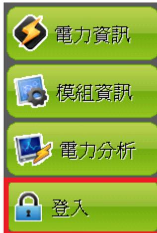
PMD-420x 的設定操作需以具備系統管理者登入權限的密碼(預設密碼：**Admin**)登入後才可進行後續操作。當”登入”視窗出現後。請輸入系統管理者密碼以進行後續的系統設定。
