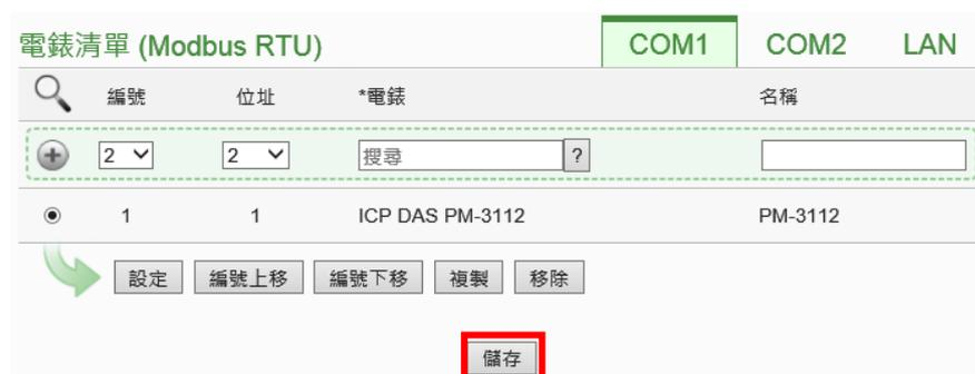
**注意：**當掃描不到電錶時，請再次確認 RS-485 線路串接正確，並至步驟(1)：【系統參數設定】→【I/O 介面設定】確認電錶所連接 COM Port 設定參數無誤，修改完畢請點選【儲存】，並重覆步驟 3.a 重新掃描：
