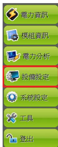
進入【設備設定】頁面後，可透過側邊導覽選單選擇【介面設定】。確認所連接 COM Port 參數(Baudrate/Parity/Stop bits)設定無誤，修改完畢請點選【套用】。
