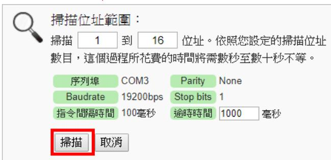
b. 系統完成掃描後即會顯示目前所連接的 M-7000 模組，點選【儲存】完成 M-7000 I/O 模組清單設定。
