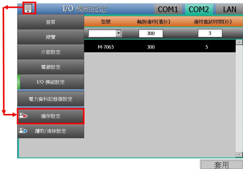
注意：當掃描不到 I/O 模組時，請再次確認 RS-485 線路串接正確，並至【介面設定】確認所連接 COM Port 設定參數無誤，修改完畢請點選【套用】，並重新掃描。
