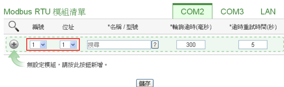
圖 7-32: Modbus RTU 模組編號與位址設定
