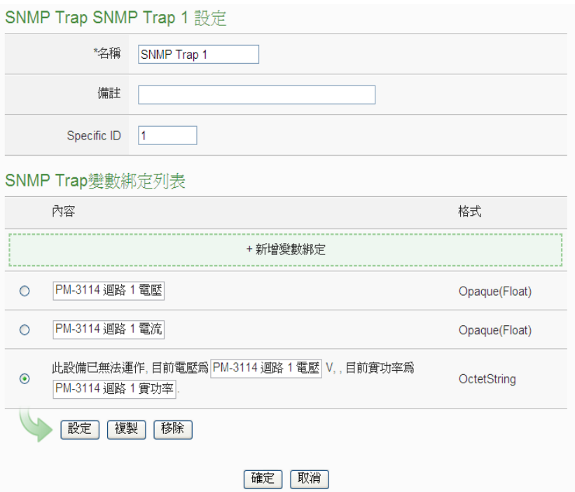
圖9-19: SNMP Trap 參數設定頁面(包含“變數綁定”列表)
