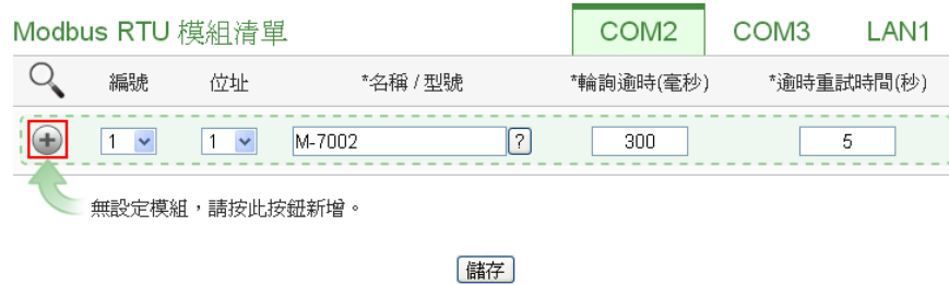
圖 7-34: 新增 Modbus RTU 模組按鈕
