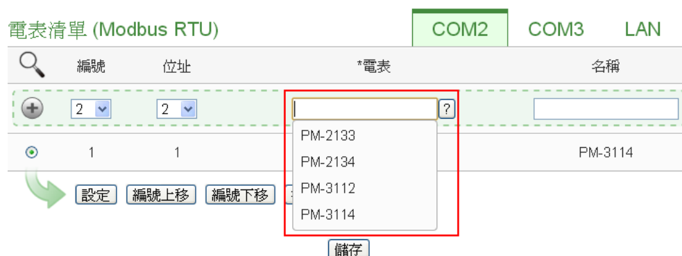
圖7-9: Modbus RTU 電錶類型設定
