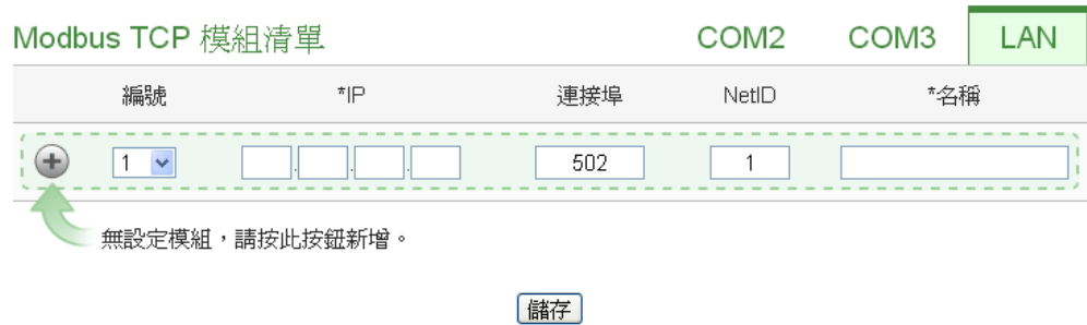
圖 7-35: 新增 Modbus TCP 模組頁面
