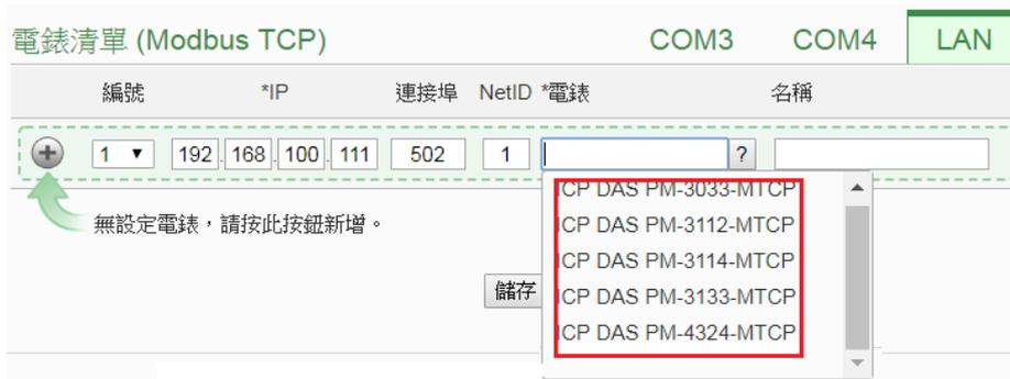
圖 7-12:Modbus TCP 电表类型设定
