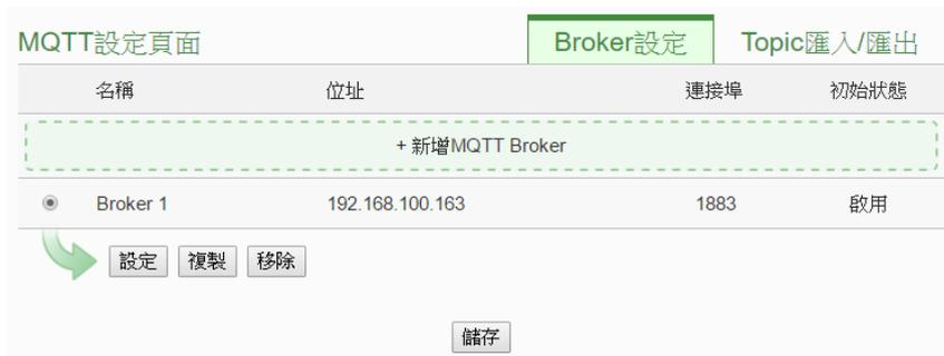
圖9-16:MQTT Broker 设定页面
