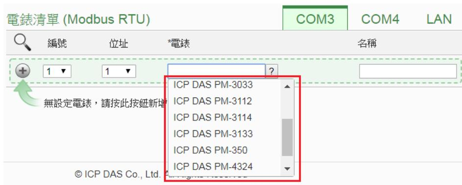
圖7-9: Modbus RTU 电表类型设定
