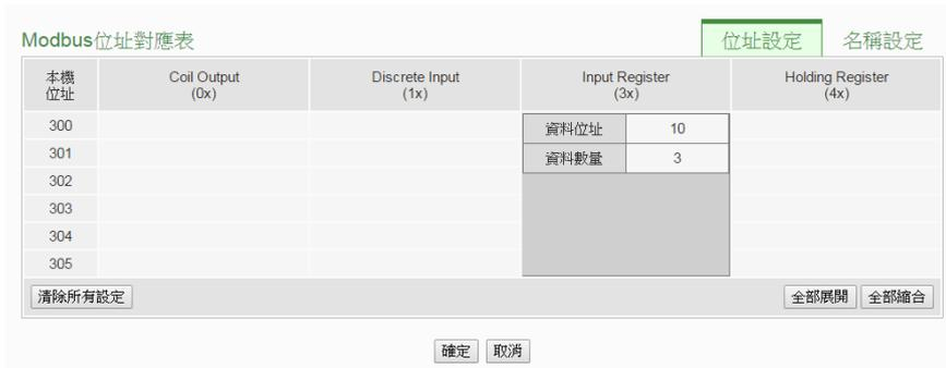
圖 7-48: Modbus RTU 模块 Input Register 数据设定页面范例
