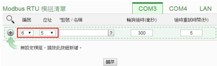
圖 7-32: Modbus RTU 模块编号与地址设定
