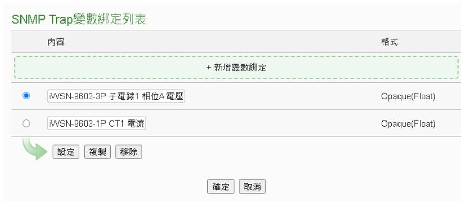
圖 10-9: 透过“信道数据”类型所编辑的”变量绑定”列表
