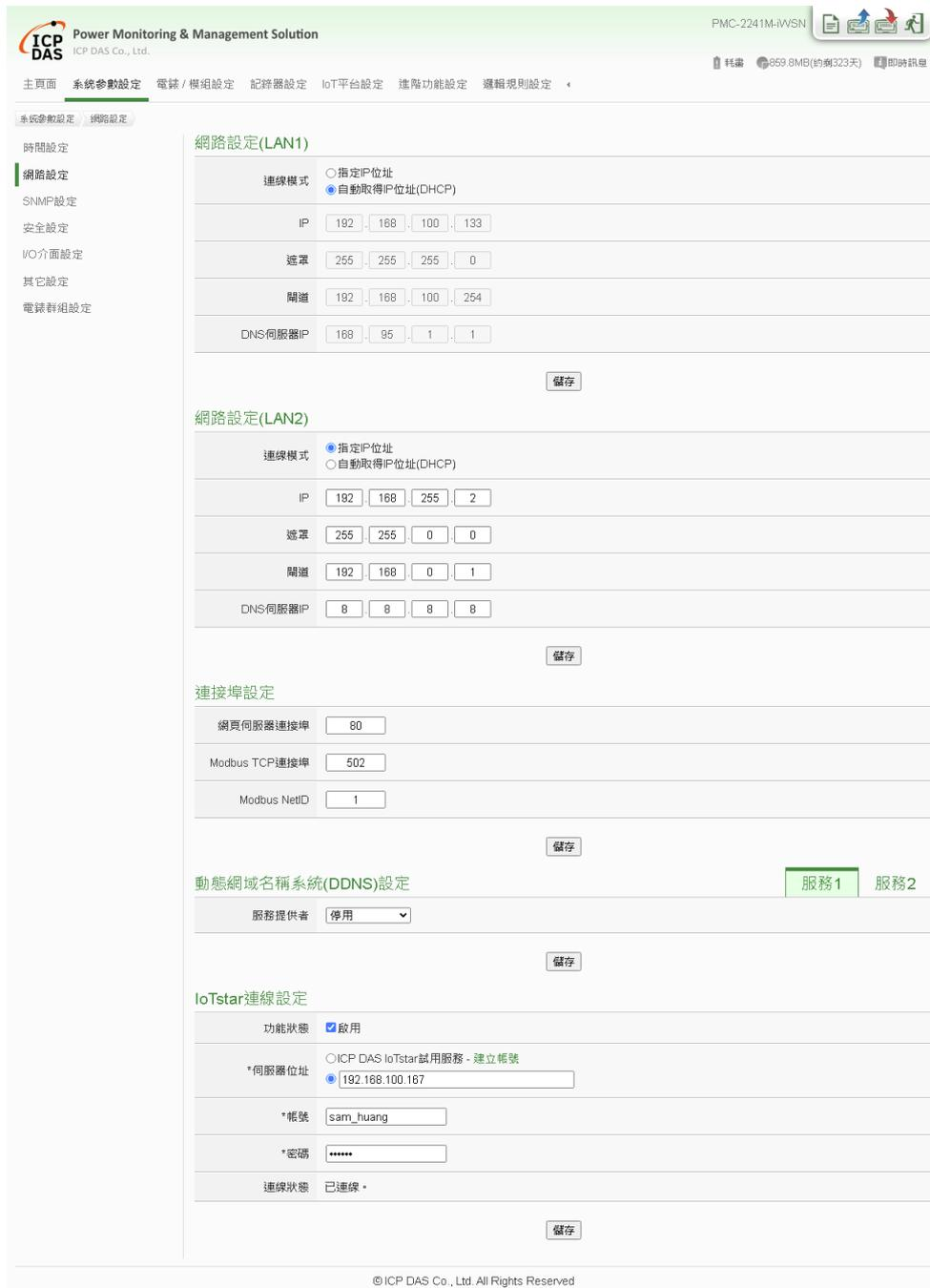
圖 6-4: PMC 控制器网络设定页面
