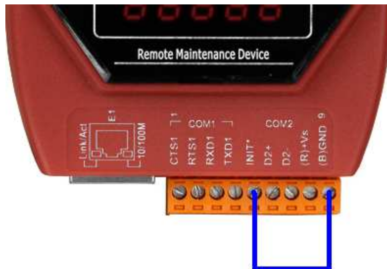
圖 七恢復出廠設定的接腳
