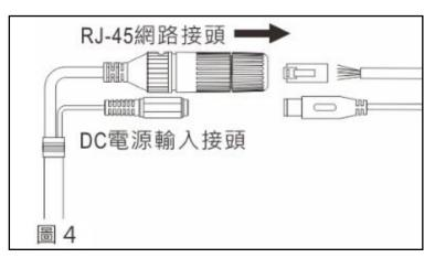
搭配防水接頭連接 RJ-45 網路線 首先將防水接頭取下,並將防水螺帽旋開;穿過網路線後再 使用工具連接 RJ-45 接頭(圖 5)。將 RJ-45 接頭連接至網路 攝影機,再依序將防水接頭、防水螺帽旋緊(圖 6)。
