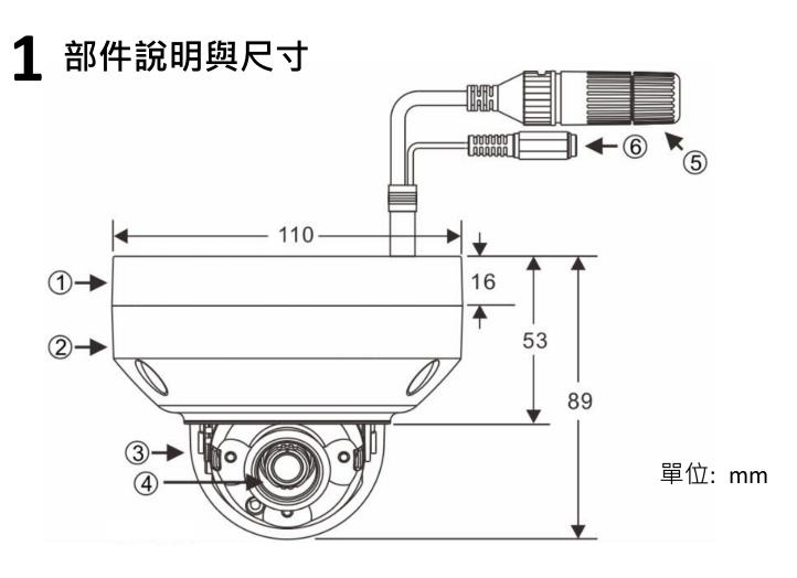
①底座 ②上蓋 ③透明罩 ④鏡頭 ⑤RJ-45 網路接頭(支援 PoE 供電) ⑥電源輸入(DC12V±10%) ⑦Micro SD 卡插槽 ⑧回復工廠預設值按鍵
