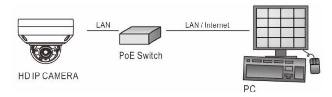
(3). 使用 PoE 供電器(Power Injector)和網路交換器連接網路。
