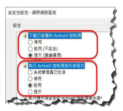
完成後,可利用攝影機預設的 IP 位址,使用網際網路瀏覽器在網址列輸入預設的 IP 位址,存取 IP 攝影機的影像,第一次使用 IP 攝影機時,網際網路瀏覽器將提示下載「ActiveX 控制項與外掛程式」,請按下確認鍵來下載。
