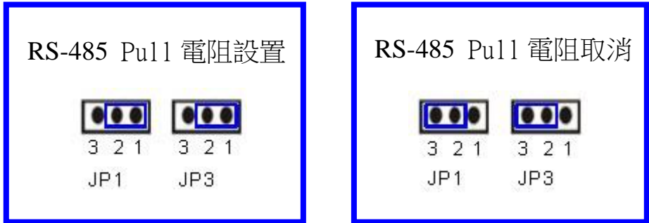
圖十一 GW-7552-B / GW-7552-M 內部 Pull high/low 電阻設定
