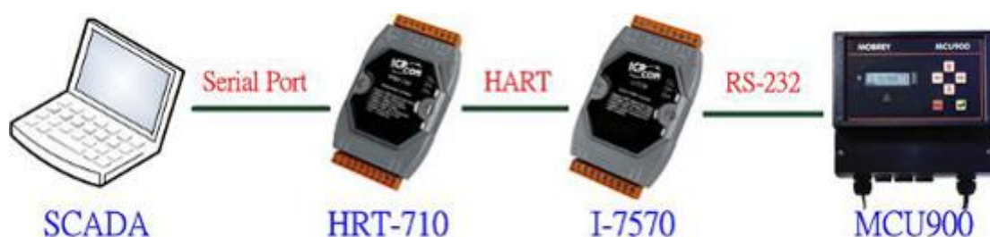
圖 10-1：整合 MCU900 之硬體接線
