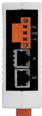
圖 2: ECAT-2093 包含電源與 EtherCAT 介面的側視圖
