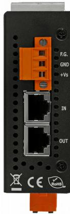
圖 3: ECAT-2091S 包含電源與 EtherCAT 介面的側視圖
