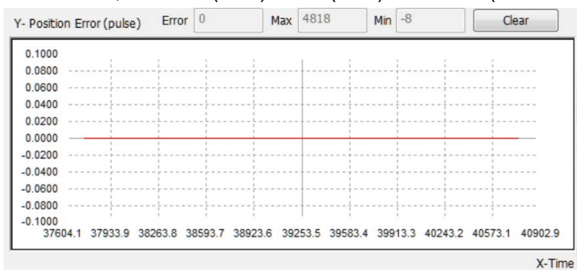
● 位置誤差顯示框，顯示主軸與從軸的位置誤差(單位: pulse)，Error 為當前誤差，Max 為最大誤差，Min 為最小誤差，按下 Clear 可以清除 Max 與 Min 的數值。
