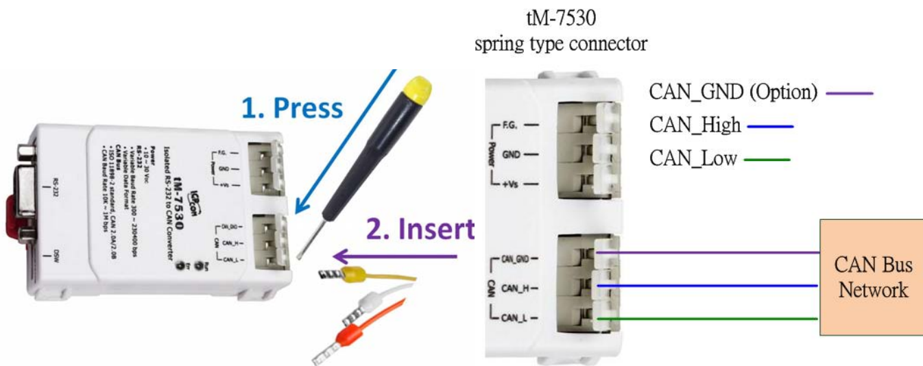
圖：tM-7530 CAN 總線接線方式
