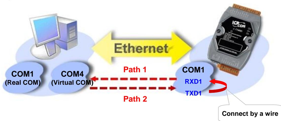
Step 2: 使用 VxCommUtility 将 I-7540D 的 COM1 端口虚拟成计算机的 COM4。
