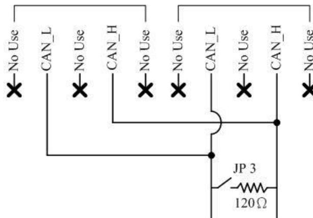
图 2-3: CAN 总线接头上的电路图
