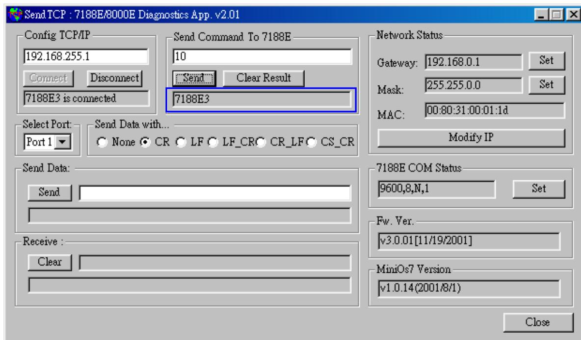
Step 4: 选择「Port 2」与「CR」后, 输入“\$02M”字符串并且传送, 以读取 I-7540DCOM2 端口上的模块 ID。如果你启用 7000 模块的 checksum 功能, 请选择「CS\_CR」。「CS\_CR」选项的作用为在发送字节后加了两个 Checksum 字节, 再加上「CR」。
