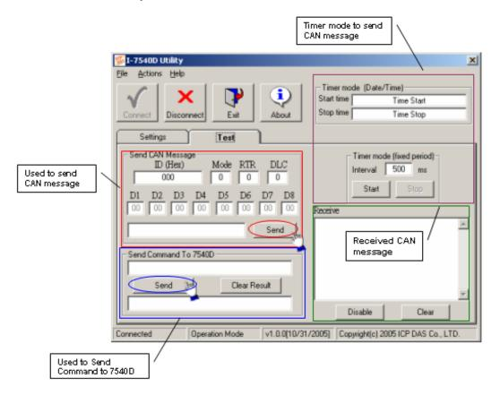
Step 4: 勾選「Use CAN Message」並在 Utility A 輸入 CAN 訊息。之後,點擊「Send」,Utility 將 CAN 訊息自動轉換成帶有 ASCII 0x0D 結尾的字串並經過乙太網路傳送至 I7540D\_A。待 I-7540D\_A 接收到該字串後,I-7540D\_A 將轉換字串成 CAN 訊息。因此,I-7540D\_B 接收到由 I-7540D\_A 所傳送之 CAN 訊息後,將 CAN 訊息轉換成 ASCII 字串,並透過先前建立好的 Socket 傳送該字串至 Utility B,詳細步驟如下圖所示:
