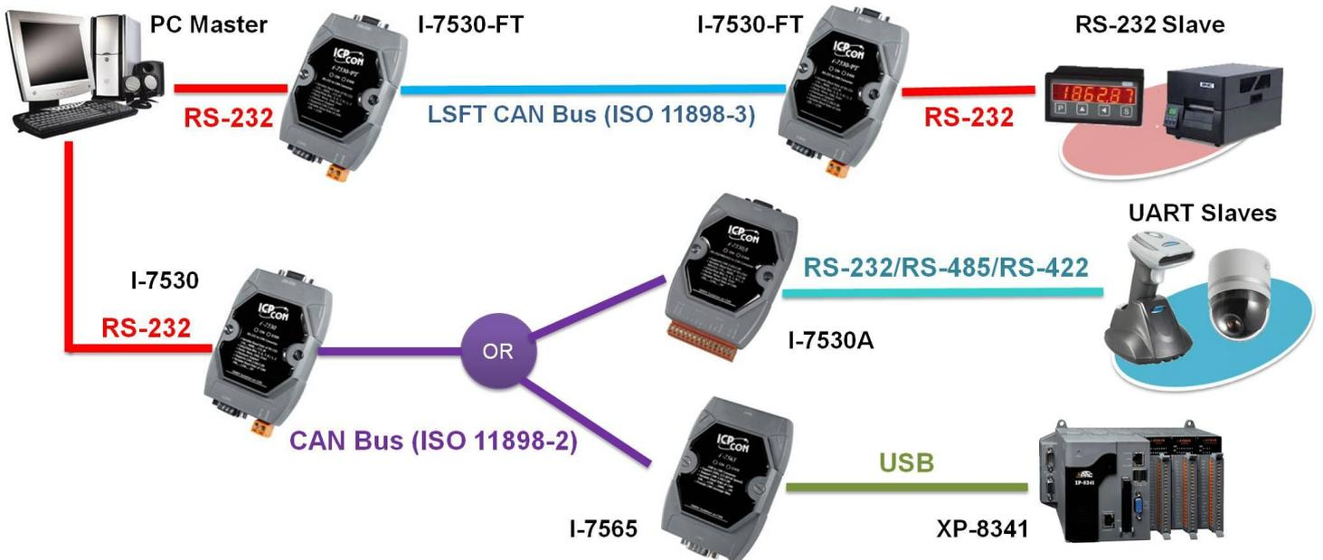
备注：若使用者想余透明传输或成对传输的应用中使用 CAN 转换器，请将模块设为成对传输模式(Pair Connection Mode)。详细设定方式，请参考 3.1 章节
