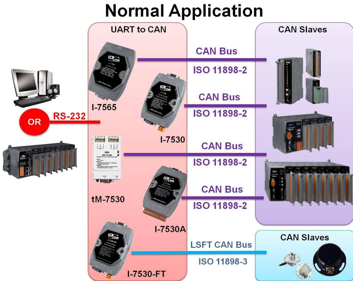
为了适应市场需求, 我们为了一些特殊的应用而衍生了转换器上的功能。当 UART 类型的传感器与致动器需要用于 CAN 网络上时, 透明传输是一种有效的方法。为了增进通讯速度或延长通讯距离, 成对传输模式(Pair Connection)可以帮助 PC 与其它 RS-232/RS-485/RS-422/USB 设备透过 CAN 总线达到此目的。相关应用请参考下方图片:
