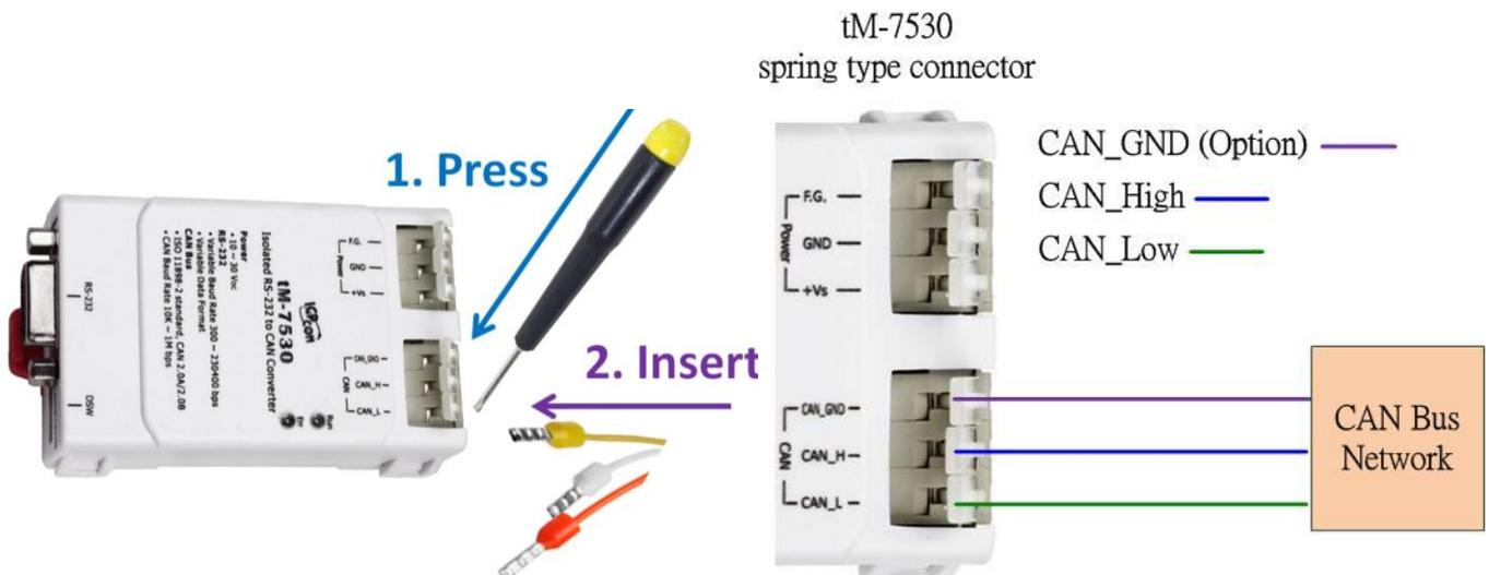
图: tM-7530 CAN 总线接线方式
