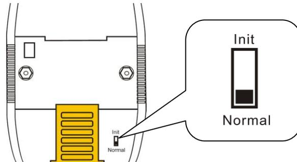
而 tM-7530 的指拨开关位于模块的底部。
