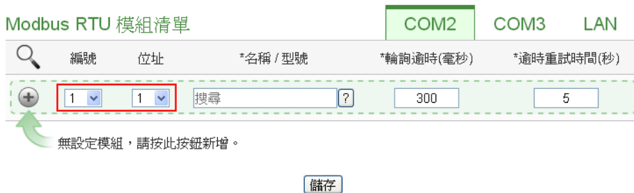
圖 7-32: Modbus RTU 模組編號與位址設定
