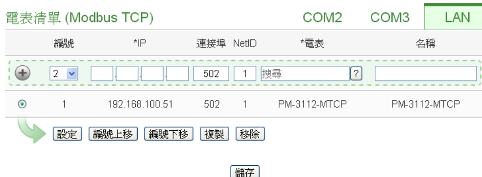
圖7-11: 新增 Modbus TCP 電錶頁面
