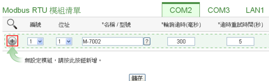
圖 7-34: 新增 Modbus RTU 模組按鈕
