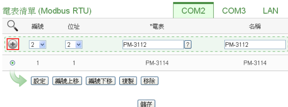
圖7-10: 完成手動新增 Modbus RTU 電錶
