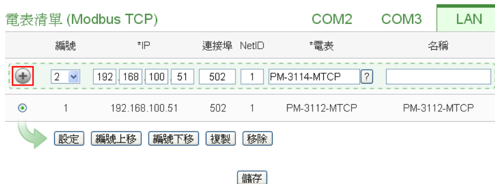
圖7-13: 完成手動新增 Modbus TCP 電錶
