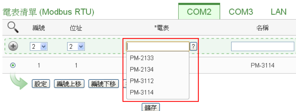
圖 7-9: Modbus RTU 電錶類型設定
