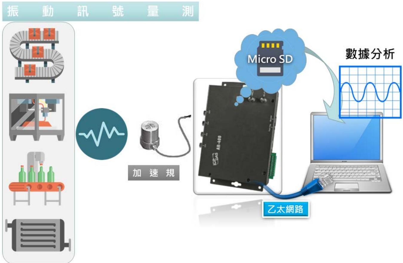
近年來在智能工廠風潮快速的崛起下，機台自動化、無人化、智能化將會是未來主流的趨勢，機台震動監測可以預防機台損壞所導致的損失，讓廠務人員在機台出現損壞徵兆前，可以預先進行保養修復，避免損害加劇導致需大規模停機維修，降低生產效益。市面上最常被用於機台軸承震動訊號量測的 **IEPE** 加速規感測器通常需外加驅動模組，這樣不但需增加成本，也讓量測的結果多了不確定性，另外市面常見的加速規記錄器取樣範圍也無法達到機台軸承震動診斷範圍，為讓達到工廠智能化最佳的效益。泓格科技開發了加速規數據記錄器產品，**AR-200** 及 **AR-400**。
