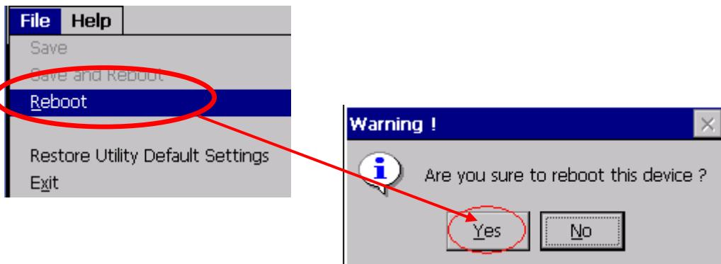
步驟 4.7: 重開機後，當連上網路，系統將自動與網路時間校正伺服器比對時間，進行系統時間校正動作
