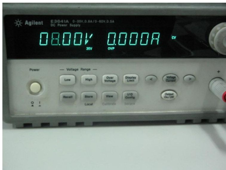
電源供應器輸出 8.00V 電壓給模組
