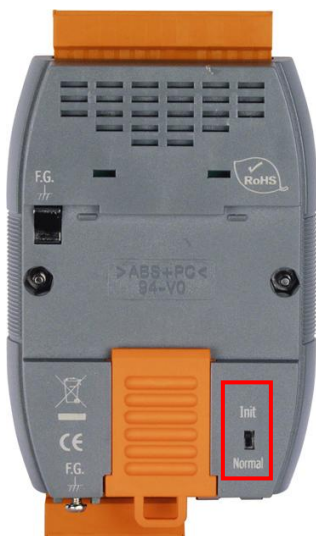
图 2-1: 控制器上的 Switch 位置图
