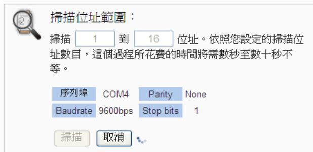
圖 6-24：泓格內建 Modbus RTU 模組掃描進行中
