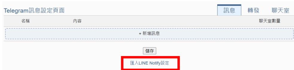
在 Telegram 設定頁面的下方，有“匯入 LINE Notify 設定”的功能選項，點選之後會將 LINE Notify 的訊息及相關設定複製到 Telegram 設定當中，邏輯規則也會將發送 LINE Notify 訊息的動作轉換成發送 Telegram 訊息。但因 Telegram 聊天室與 LINE Notify 聊天室的結構不同，使用者仍須手動進行 Telegram 聊天室的替換。
