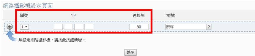
圖 6-48：iCAM 網路攝影機編號、IP 及連接埠設定
