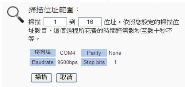
圖 6-23：泓格內建 Modbus RTU 模組掃描範圍設定
