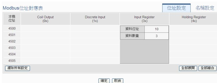
圖 6-40：Modbus RTU 模組 Input Register 資料設定頁面範例
