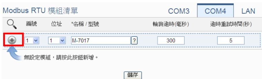
圖 6-29：新增 Modbus RTU 模組按鈕
