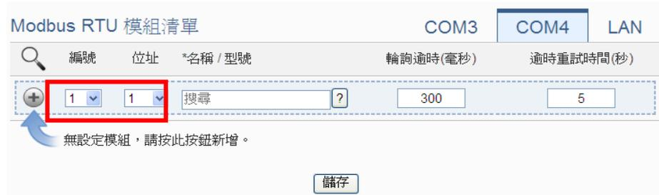
圖 6-27：Modbus RTU 模組編號與位址設定
