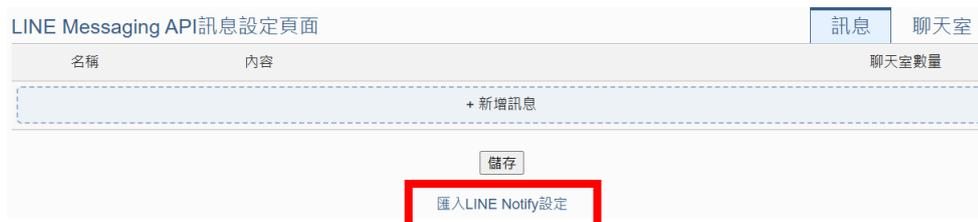
在 LINE Messaging API 訊息設定頁面的下方，有“匯入 LINE Notify 設定”的功能選項，點選之後會將 LINE Notify 的訊息及相關設定複製到 LINE Messaging API 設定當中，邏輯規則也會將發送 LINE Notify 訊息的動作轉換成發送 LINE Messaging API 訊息。但因 LINE Messaging API 聊天室與 LINE Notify 聊天室的結構不同，使用者仍須手動進行 LINE Messaging API 聊天室的替換。
