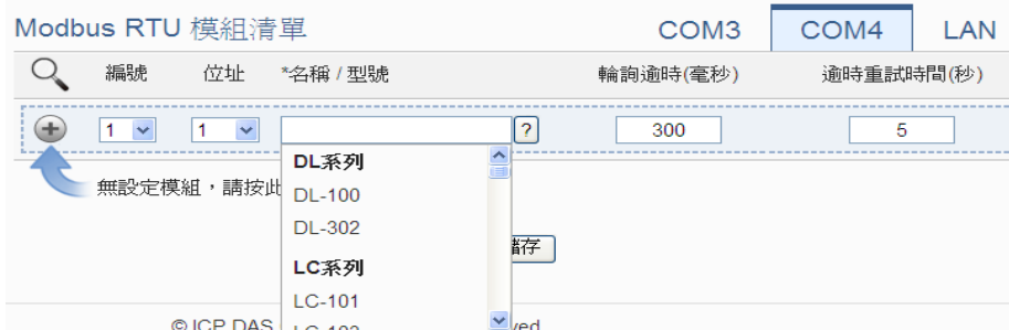
圖 6-28：Modbus RTU 模組名稱/型號設定
