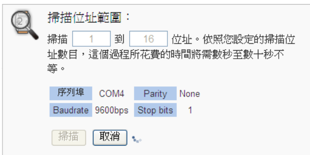
圖 6-24：泓格內建 Modbus RTU 模組掃描進行中
