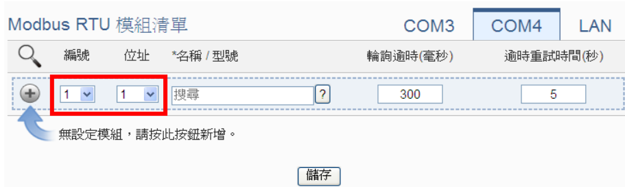
圖 6-27：Modbus RTU 模組編號與位址設定
