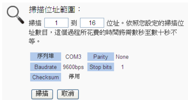
圖 6-9：I-7000/DL DCON 模組掃描範圍設定
