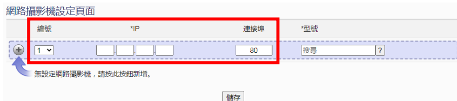
圖 6-51：iCAM 網路攝影機編號、IP 及連接埠設定
