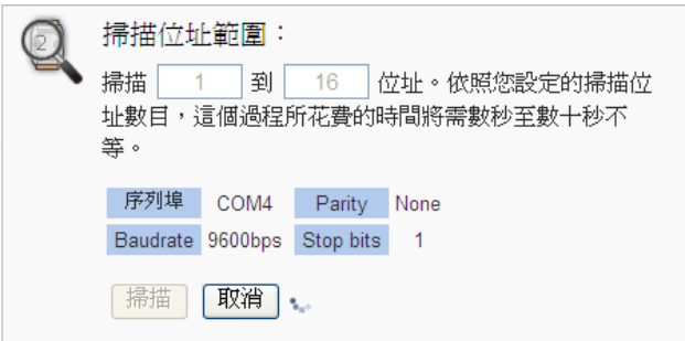
图 6-24: 泓格内建 Modbus RTU 模块扫描进行中
