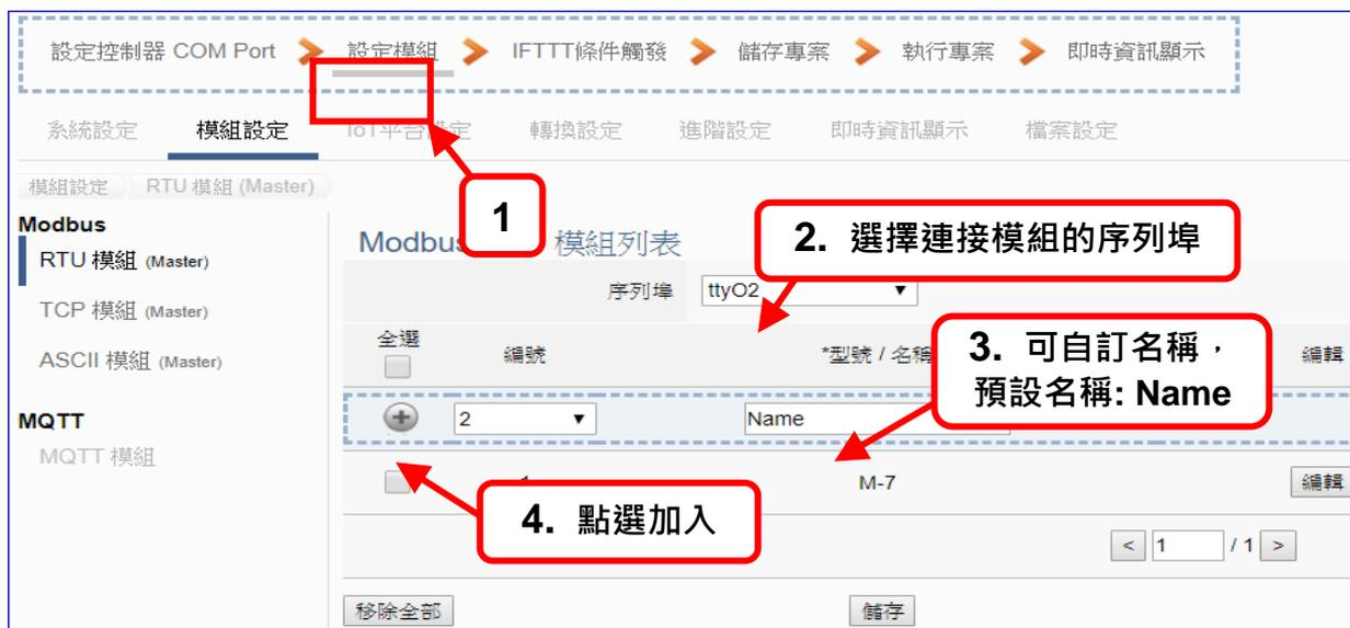
加入模組後 (如下圖，例: 編號 1 的 M-7)，請再點選模組的 **[編輯]** 按鈕，進入模組內容設定的頁面。
