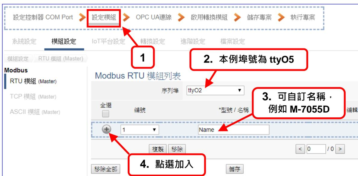
加入模組 M-7055D 後 (如下圖)，請再點選 [編輯] 按鈕，進入模組內容設定的頁面。
