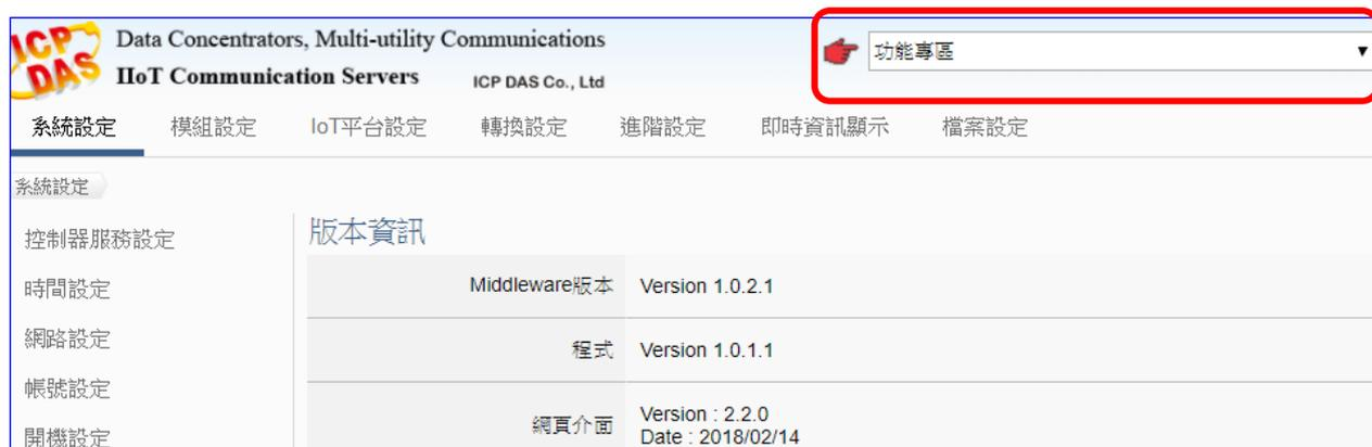
[步驟框] (如下圖) 是功能專區的特色，提供精靈式(Wizard) 一步步的指引步驟，點選步驟即可自動切換到需要設定的功能畫面，依照步驟即可完成流程所需的所有功能設定。
