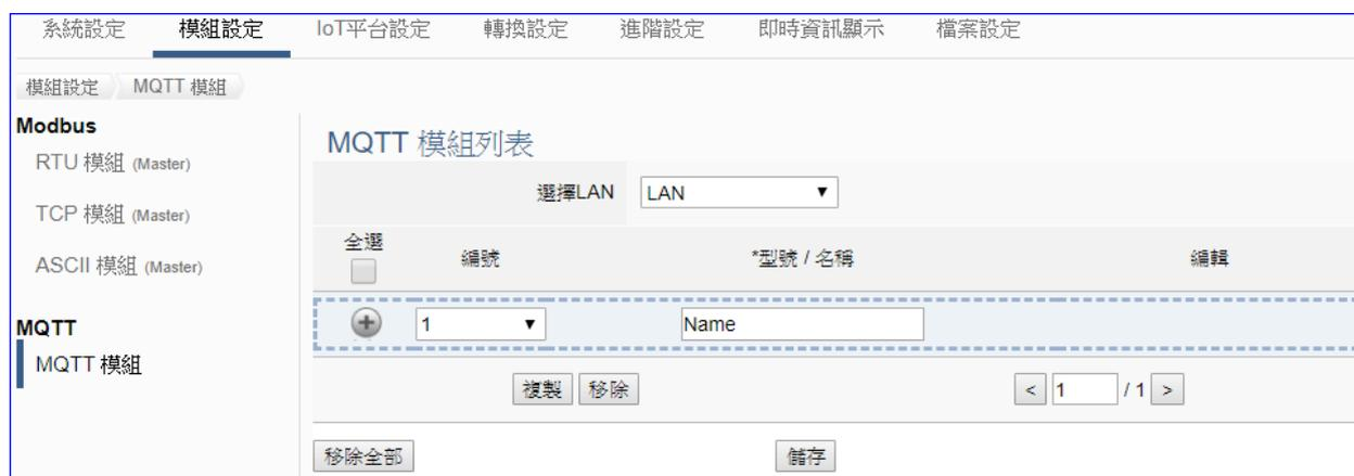
UA 系列控制器使用 Ethernet LAN 埠和 MQTT 模組連接，LAN 上面連線的模組，可自行設定模組名稱以方便辨識 (預設名稱: Name)，點選 [ + ] 按鈕可新增一個 MQTT 模組，模組列表如下圖的 Name。接著，點選該模組的 [編輯] 按鈕進一步設定該模組 I/O 通道的 MQTT 變數表。
