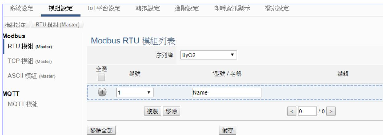
UA 系列控制器使用序列埠和 Modbus RTU 模組連接，每個序列埠上面連線的模組，可自行設定模組名稱以方便辨識 (預設名稱: Name)，點選 [ + ] 按鈕可新增一個 RTU 模組，模組列表如下圖的 Example2。接著，點選該模組的 [編輯] 按鈕進一步設定該模組 I/O 通道的 Modbus 位址對應表。
