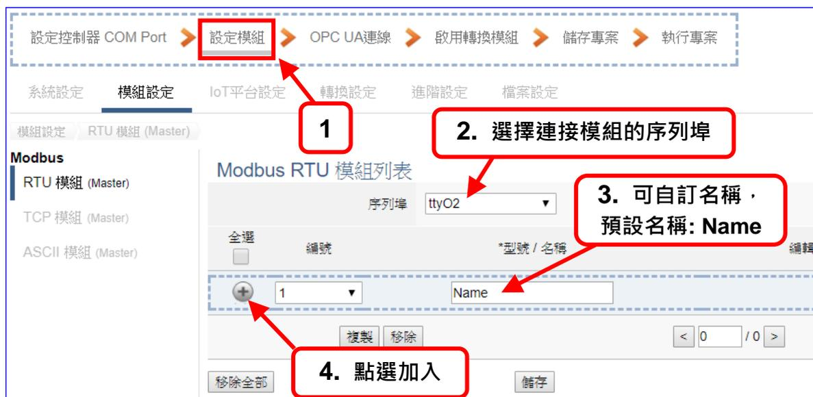
加入模組後 (如下圖，例: 編號 1 的 Example1)，請再點選模組的 [編輯] 按鈕，進入模組內容設定的頁面。
