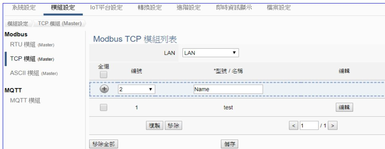
UA 系列控制器使用 Ethernet LAN 埠和 Modbus TCP 模組連接，LAN 上面連線的模組，可自行設定模組名稱以方便辨識 (預設名稱: Name)，點選 [ + ] 按鈕 可新增一個 TCP 模組，模組列表如下圖的 Name。接著，點選該模組的 [編輯] 按鈕進一步設定該模組 I/O 通道的 Modbus 位址對應表。
