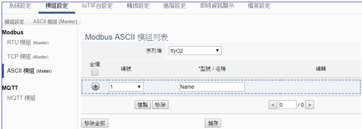
UA 系列控制器使用序列埠和 Modbus ASCII 模組連接，每個序列埠上面連線的模組，可自行設定模組名稱以方便辨識 (預設名稱: Name)，點選 [ + ] 按鈕 可新增一個 ASCII 模組，模組列表如下圖的 Name。接著，點選該模組的 [編輯] 按鈕進一步設定該模組 I/O 通道的 Modbus 位址對應表。
