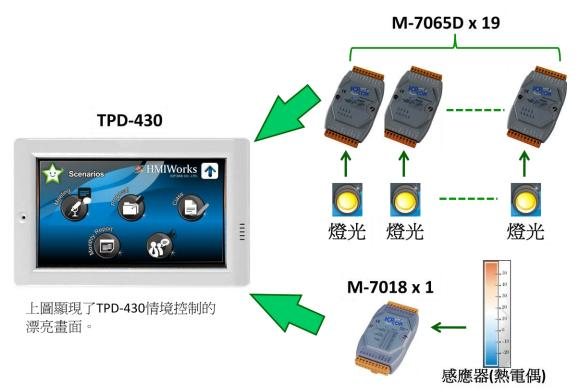
如上圖所示,以 TPD-430 來控制 Modbus RTU 模組: M-7065 和 M-7018。M-7065 用來控制燈光和空調,而 M-7018 則是用來讀回感應器(熱電偶)的值。
