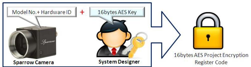
一般而言 AES 專案加密註冊碼可以儲存在任何客戶需要的週邊設備上。同時使用者也可以將註冊碼透過 `IMS_Write_DataFlash` 功能將註冊碼寫入攝影機的快閃記憶體，系統設計者可以在系統開始操作之前使用 `IMS_Read_DataFlash` 去取得註冊碼用來確認整個系統的狀態是否合法。
