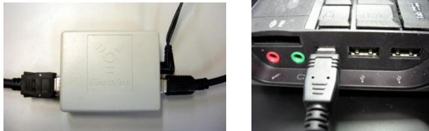
(3) 將直流電源轉換器接至 1394 Repeater 上，同時用另一條 1394a 至 1394b 雙語訊號線一頭接至攝影機另一頭接至 1394 Repeater.
