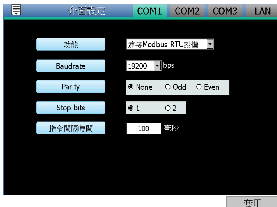
圖4-3: 連接電錶及 Modbus RTU 設備設定頁面
