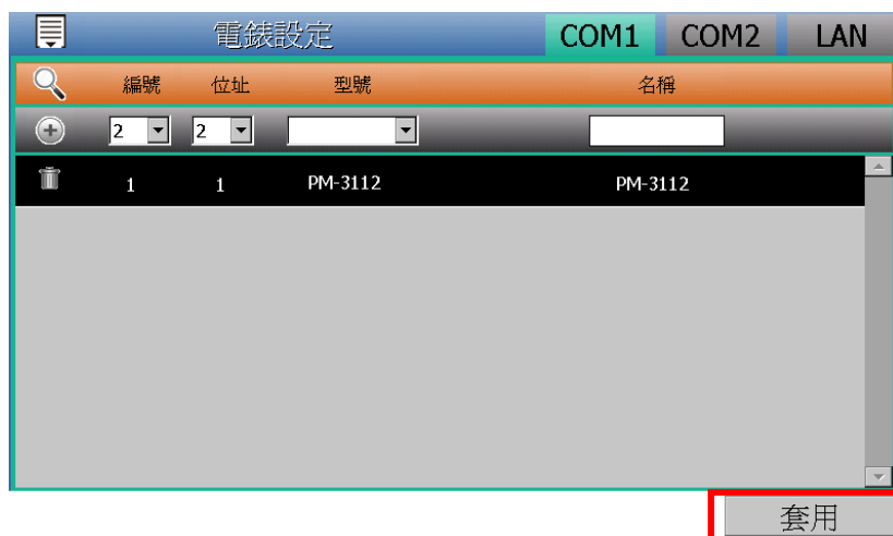
圖4-14: 完成手動新增 Modbus RTU 電錶
