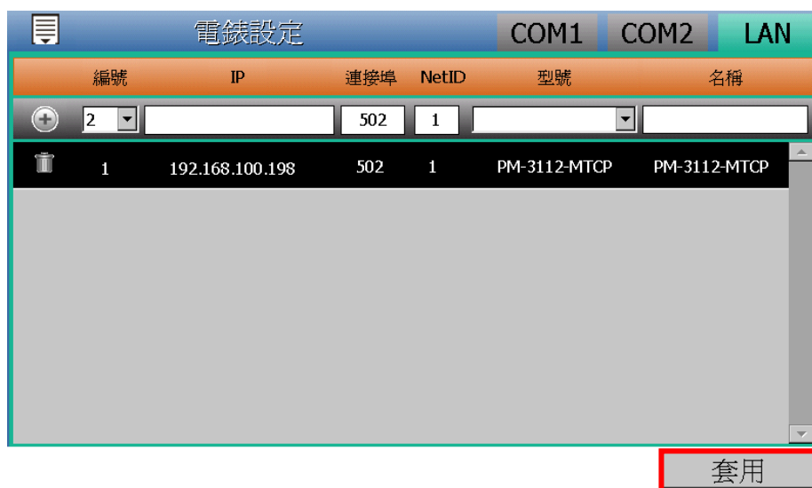
圖4-17: 完成手動新增 Modbus TCP 電錶
