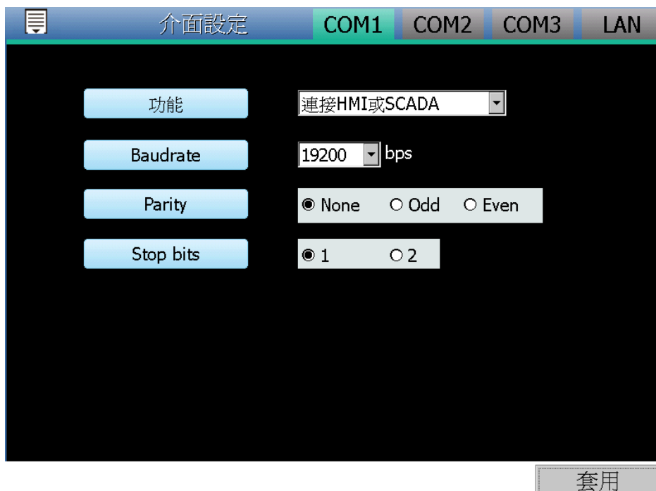
圖4-4: 連接 HMI 或 SCADA 設定頁面
