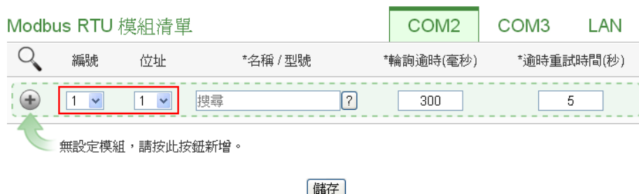
图 7-32: Modbus RTU 模块编号与地址设定
