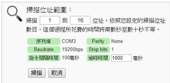
图 7-28: M-7000/DL 模块扫描范围设定
