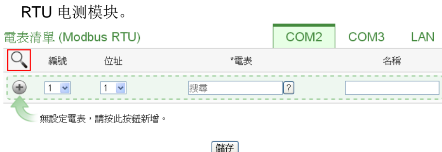
图7-3: 电测模块列表页面与电测模块扫描功能按钮
