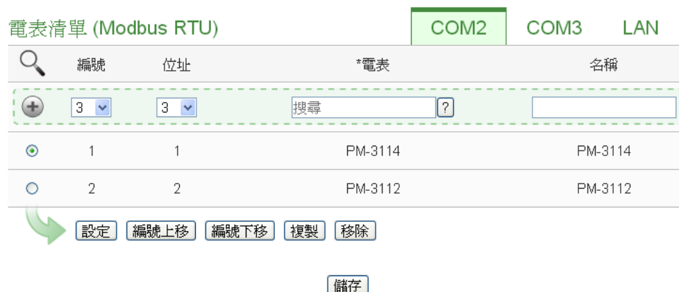
图7-2: 电测模块设定页面
