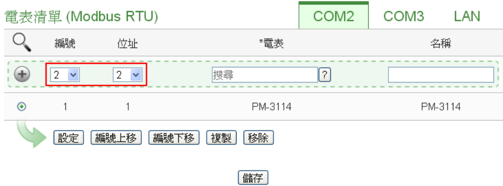
图 7-8: 电测模块编号与地址设定
