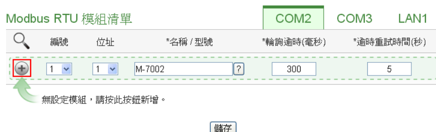
图7-34: 新增 Modbus RTU 模块按钮
