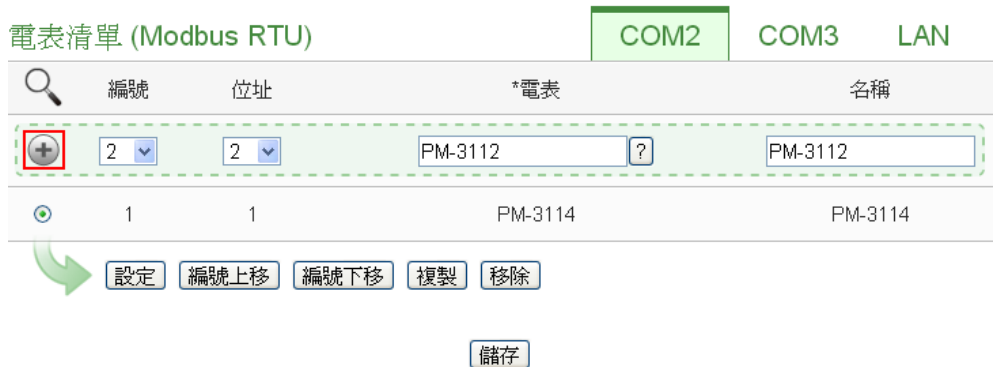
图 7-10: 完成手动新增 Modbus RTU 电测模块
