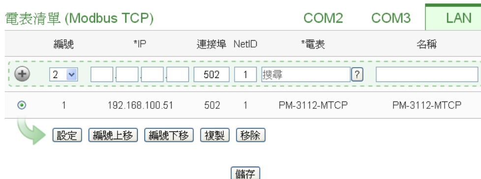
图 7-11: 新增 Modbus TCP 电测模块页面
