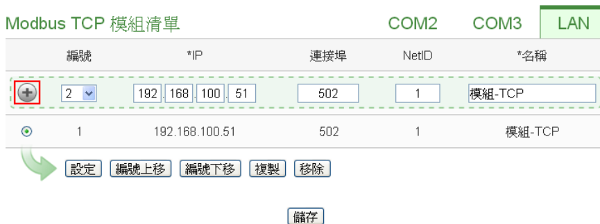
图 7-36: 新增 Modbus TCP 模块按钮
