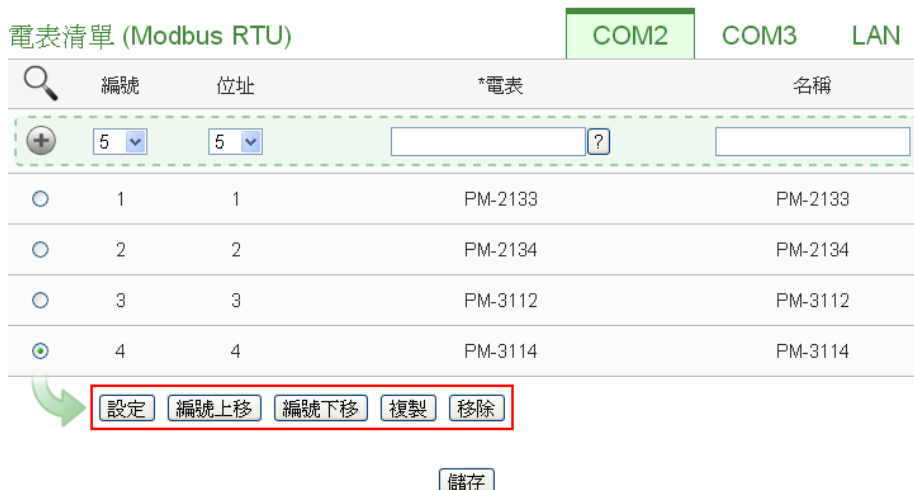
图 7-14: 电测模块列表操作接口
