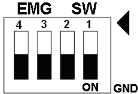
Fig. 2.7 EMG SW 設定為直接內部接 GND (預設值)
