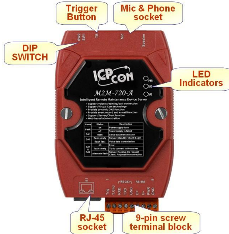
圖三 M2M-720-A 腳位配置圖
