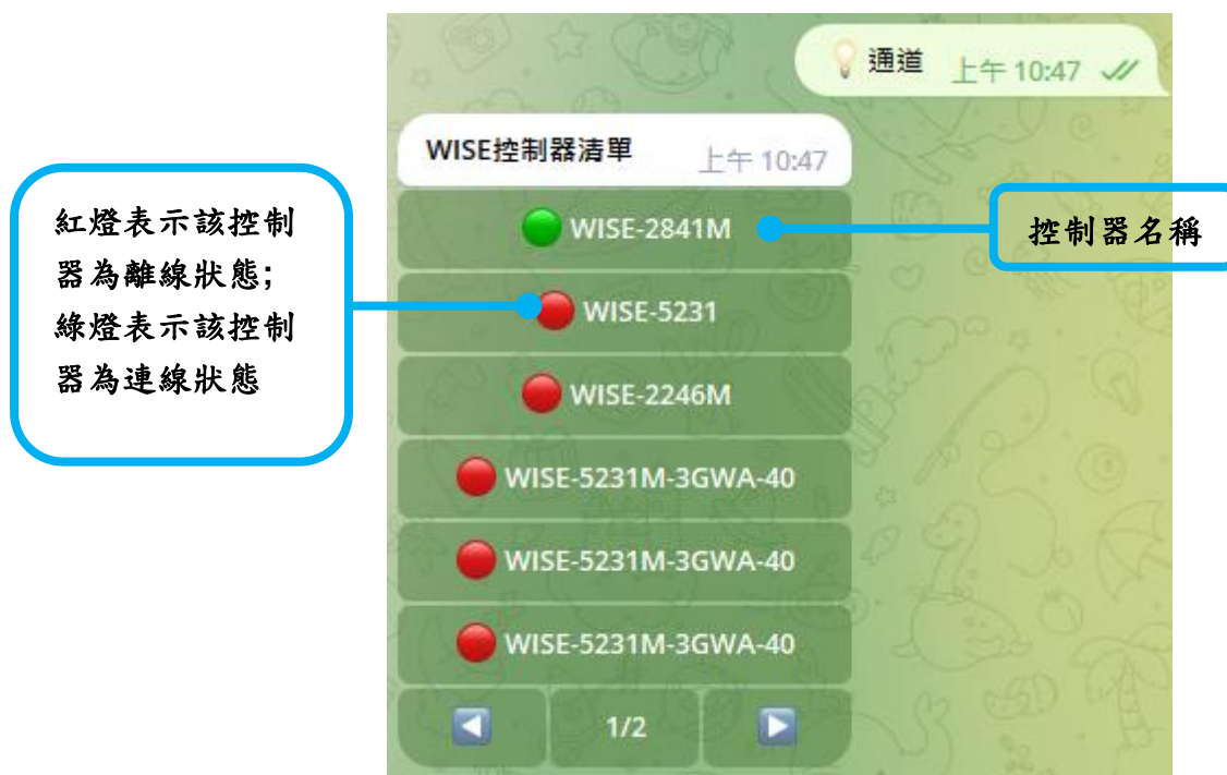
圖 3-7 : IoTstar Bot Service for Telegram—”控制器”清單
