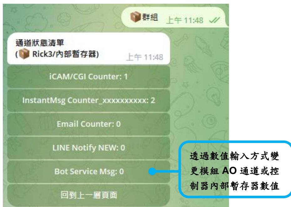
圖 3-13 : IoTstar Bot Service for Telegram 聊天室—DO 通道狀態變更
