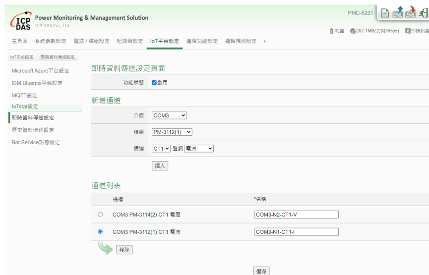
圖 2-32 : PMC/PMD 網頁－即時資料傳送設定
