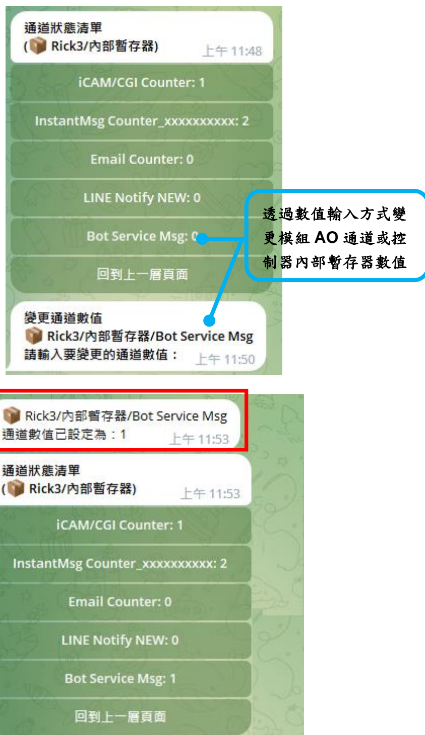
圖 3-14 : IoTstar Bot Service for Telegram 聊天室—AO 通道狀態變更
