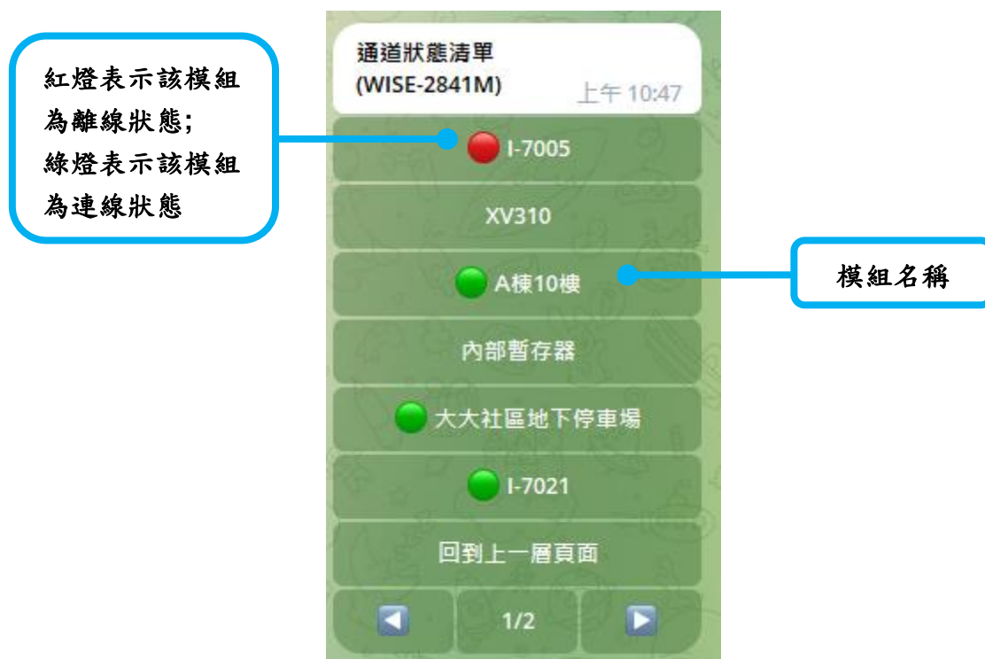
圖 3-8 : IoTstar Bot Service for Telegram—”控制器->模組”清單
