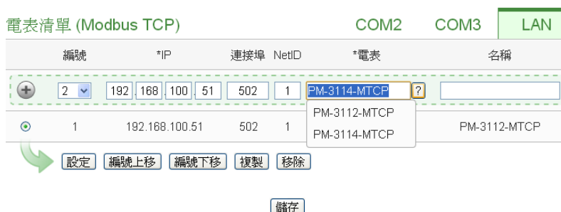
图7-12: Modbus TCP 电测模块类型设置
