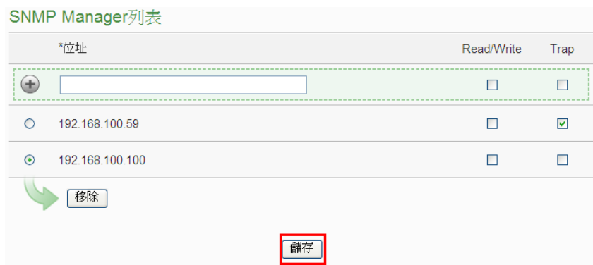
图6-12: 储存 SNMP Manager 设定
