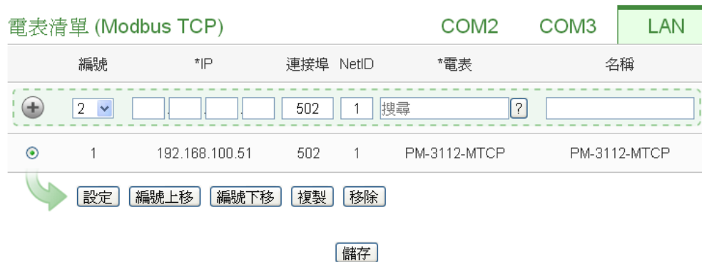
图7-11: 新增 Modbus TCP 电测模块页面
