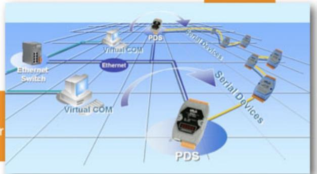
PDS 系列可编程设备服务器可将 RS-232/485/422 设备透过网络链接在一起。透过 VxComm Utility 可使 PDS 内嵌的 COM Port 仿真成为计算机主机的标准 COM Port。凭借着独立操作系统、通信协议、小尺寸及高适应性，设备服务器可以应付任何现实中的网络应用需求。大多数的设备并没有网络的端口。透过我们的可编程设备服务器可让那些设备能够链接到网络。
