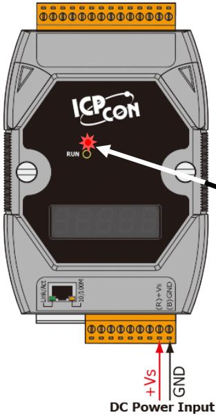
**步骤 1:** 外部供电 (+Vs, GND) 至 PDS 系列模块。
