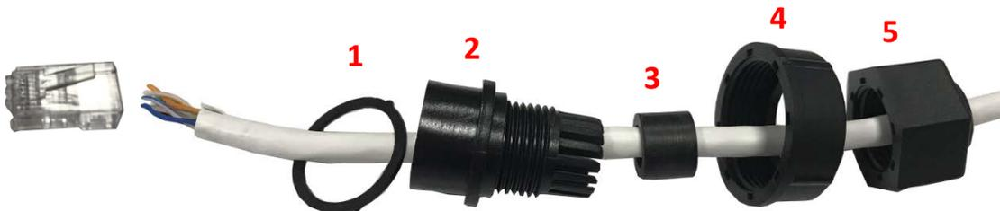
➤ **步骤 3: 将 RJ-45 接头零件连接至 RJ-45 线**
