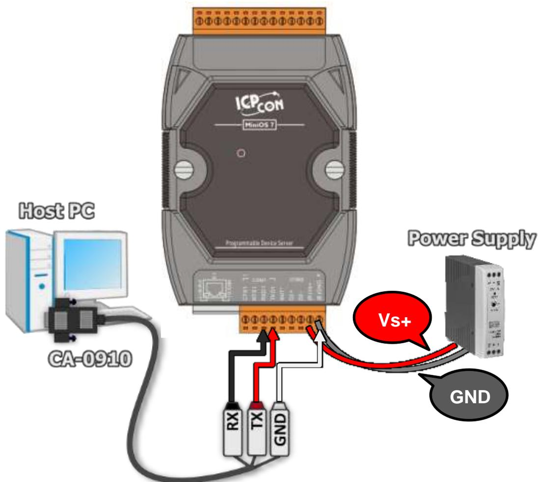
步驟 4: 取一條信號線，二端分別連接至 PDS-700 模組上的 **INIT\* Pin** 及 **GND Pin**，使模組將在 **“Init 模式”** 下進行 Firmware 更新。
