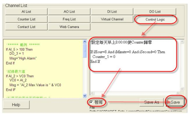
註:此段VB Script的內容設定早上 8:00:00 時將Counter\_1 通道的數值歸零,請特別注意由於判斷的參數有用到"秒"的單位,故系統設定裡的SamplingTime必須設定為每一秒取樣一次,以避免取樣的時間剛好跳過邏輯控制裡所設定要判斷的時間。
