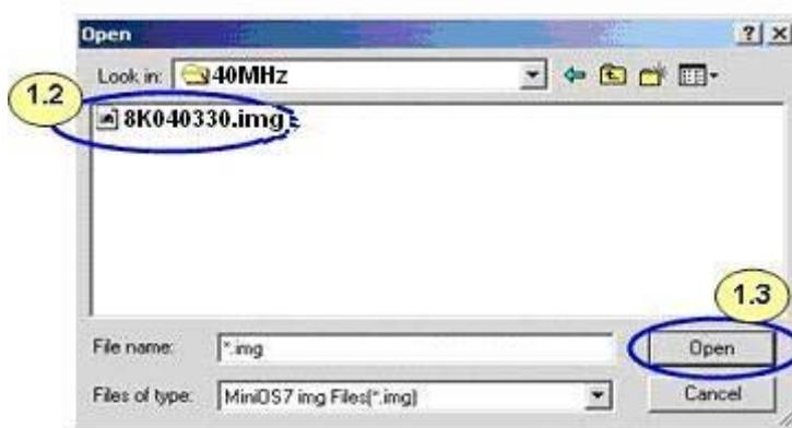
8410/8810 作業系統 image 檔是的使用在 40MHz 的處理器，故可在 40MHz 的資料夾找到欲更新的檔案，檔案名稱爲：8K040330.img
