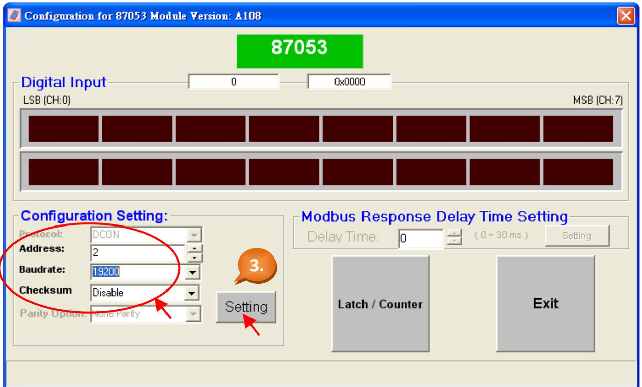
4. 您已完成設定, 請將 DIP 開關切回 “OFF”, 並將電源重新啟動。最後, 您可再次掃描模組來確認設定值。
