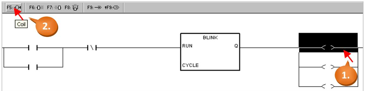
接下來，滑鼠雙擊計時器方塊中 "CYCLE" 字樣的左方，在出現的視窗中選擇 “Timer”，然後指定 Timer 的變數 “TMR1”。
