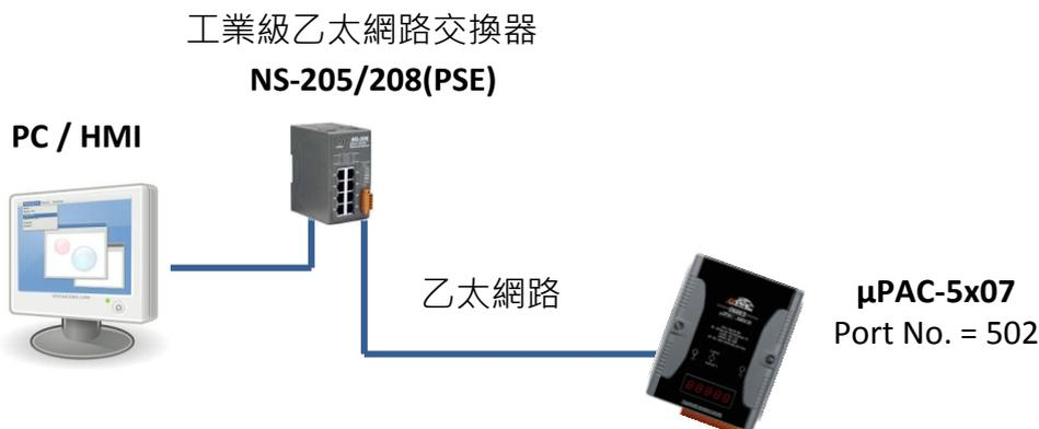
透過乙太網路埠下載 ISaGRAF 應用程式到 μPAC-5x07 控制器之前，您必須先完成乙太網路埠與 PC 連線的通訊設定。
