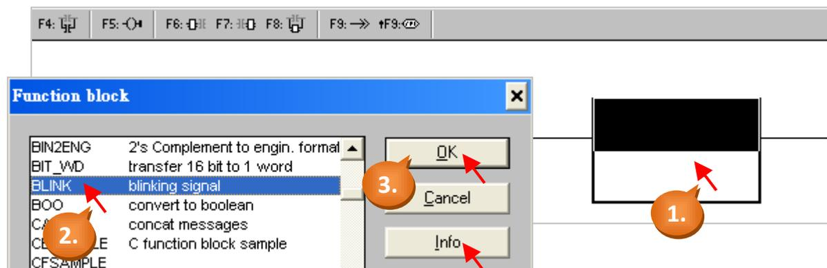
用滑鼠點選 LD 程式右方的 “output coil”，然後點選 “F5 (Coil)” 按鈕兩次，增加兩個與原來 “output coil” 平行的 “output coil”。
