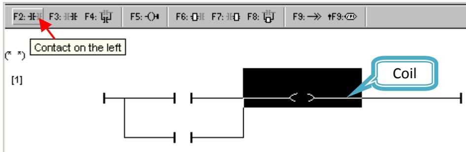
在 "Contact" 上, 點選 "Coil/contact type" 按鈕把屬性由 Normal Open 改變成 Normal Close 。
