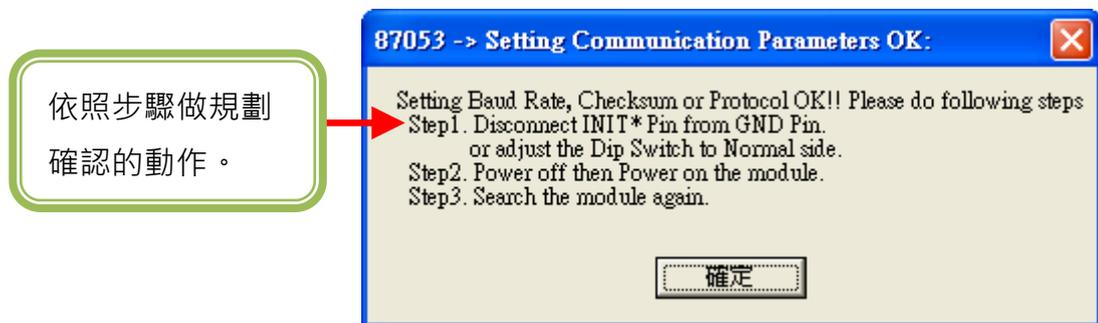
**注意:** 若您使用的是 I-7000 模塊, 務必於設定完成後移除 INIT\* 和 GND 的連接線, 再重新開啟電源。
