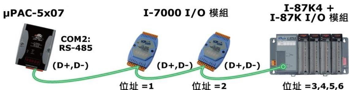
**注意:** 一台 μPAC-5x07 控制器最多可以連接 64 個 (不建議超過 40 個) I-7000 或 I-87K 系列的遠程 I/O 模組。您必須為每一個 I-7000 和 I-87K 遠端控制模組設定獨一無二的位址 (NET-ID), 並設定與控制器相同的通訊速率及 Checksum (預設: Disabled)。
